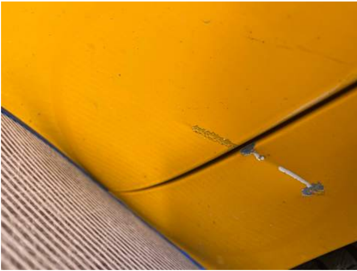
Türe hinten links (Lackschaden, Kratzer, Delle, Unsachgemäß instand gesetzt)
