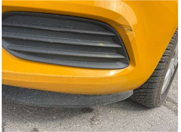
Stoßstange vorne (Lackschaden, Kratzer, Unsachgemäß instand gesetzt)
