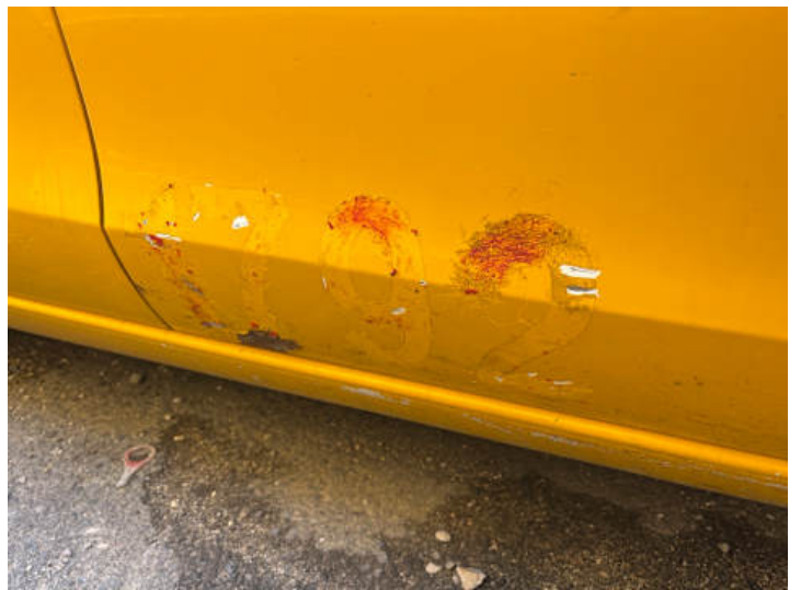
Beifahrertür (Unsachgemäß instand gesetzt, Lackschaden)
