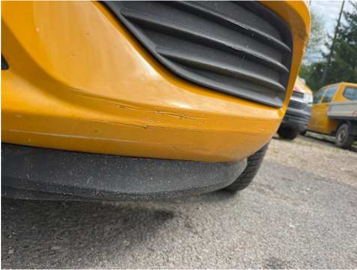
Stoßstange vorne (Lackschaden, Kratzer, Unsachgemäß instand gesetzt)
