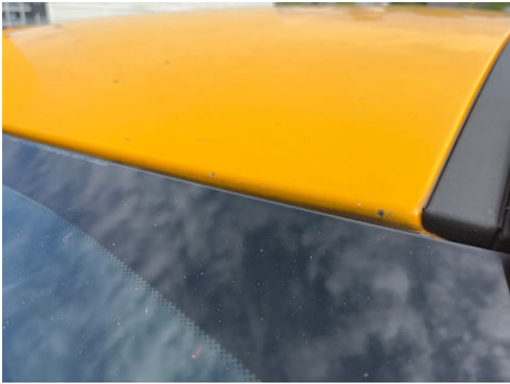
Dach (Lackschaden, Steinschlag)
