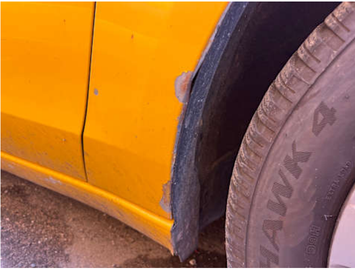
Kotflügel vorne rechts (Lackschaden, Rost)
