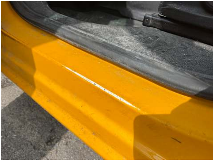
Schweller links (Lackschaden)
