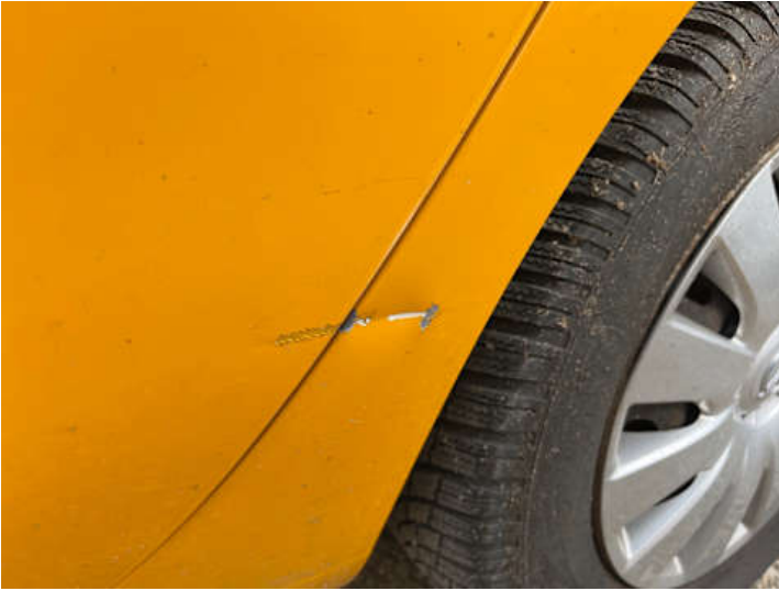
Seitenteil hinten links (Lackschaden, Kratzer, Delle)
