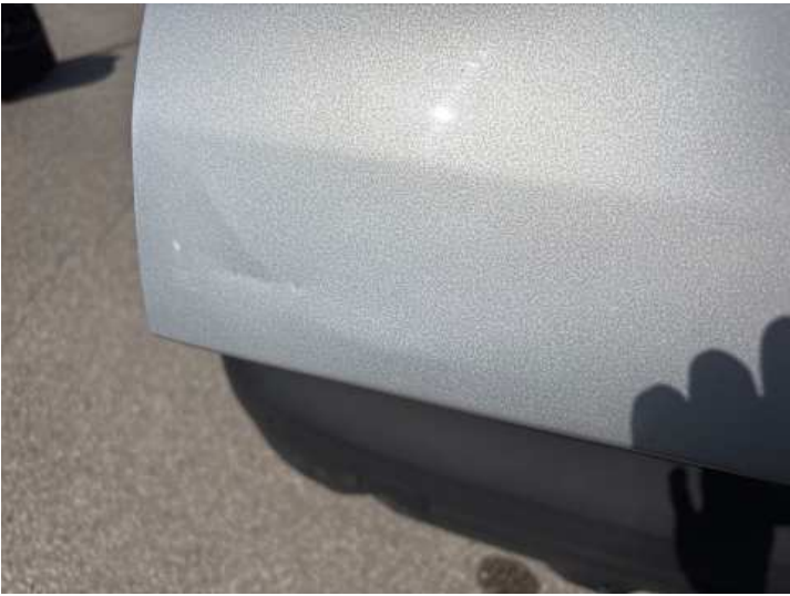
Heckklappe (Rost, Unsachgemäß instand gesetzt)
