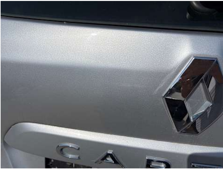
Heckklappe (Rost, Unsachgemäß instand gesetzt)
