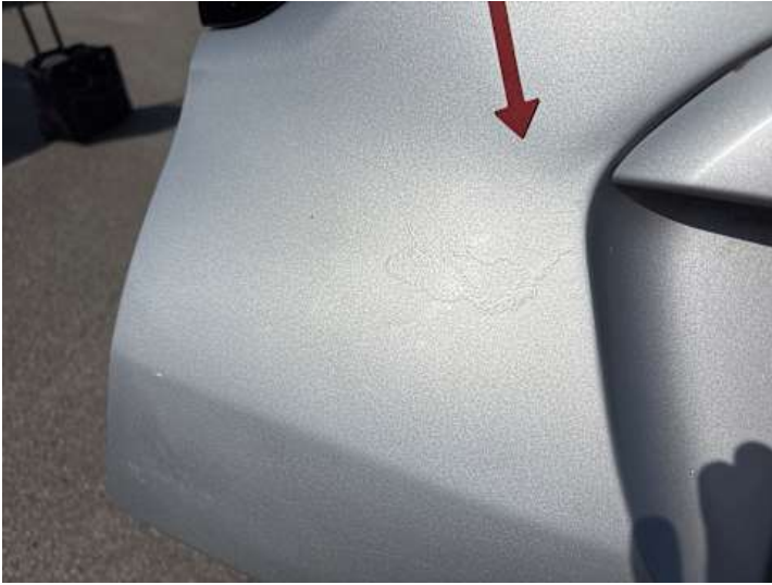
Heckklappe (Rost, Unsachgemäß instand gesetzt)
