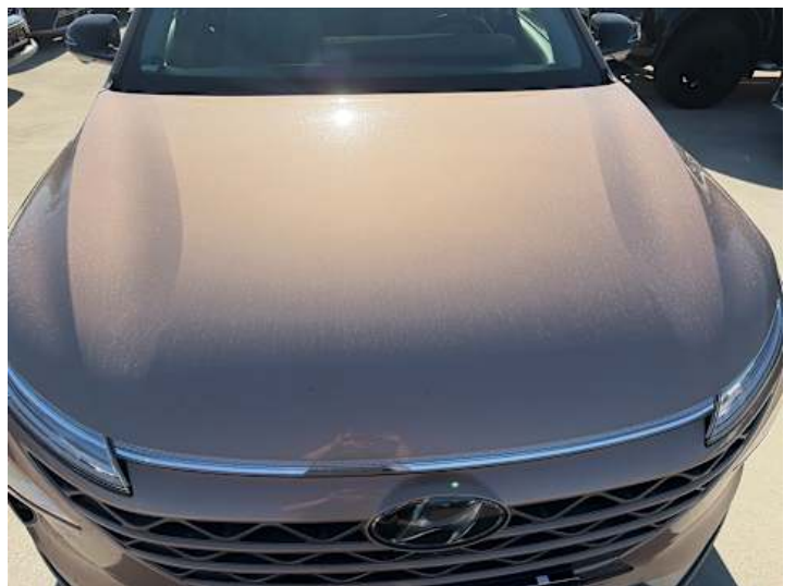
Motorhaube (Steinschlag, Lackschaden)
