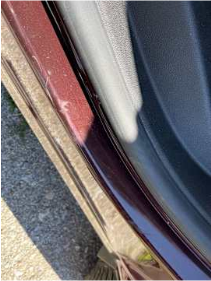
Schweller links (Kratzer)
