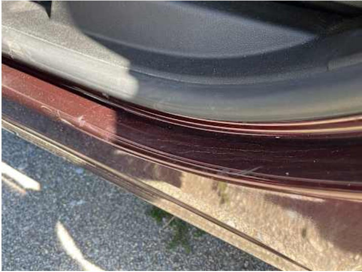
Schweller links (Kratzer)
