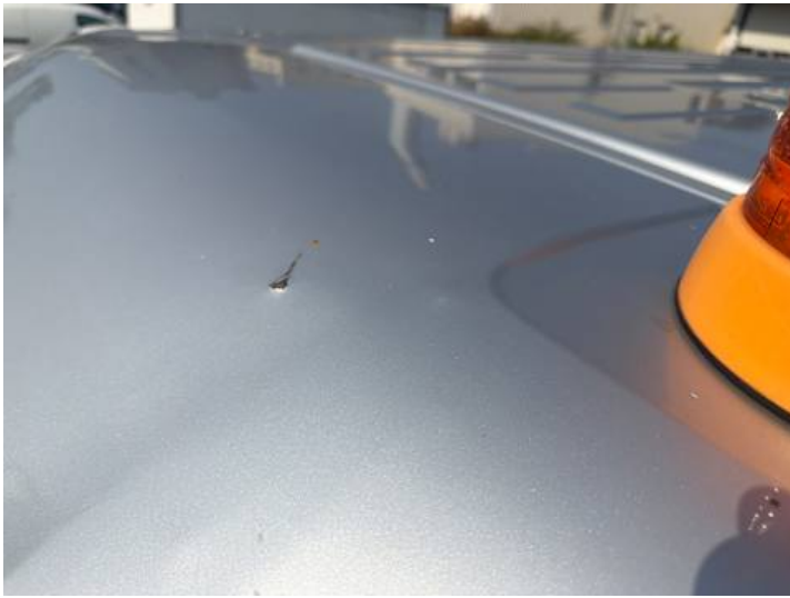
Dach (Lackschaden, Delle)
