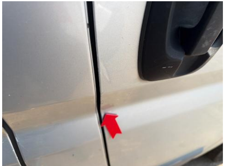
Beifahrertür (Riss/Bruch, Lackschaden, Kratzer)
