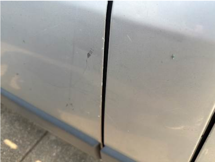
Türe hinten rechts (Kratzer, Lackschaden)
