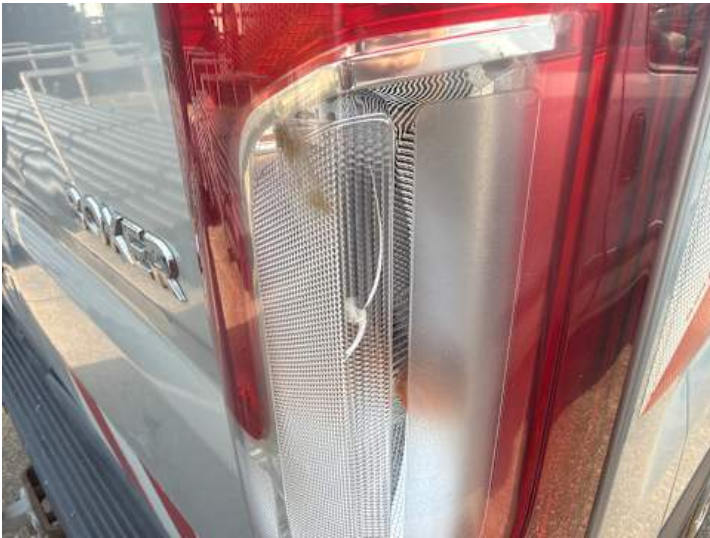
Rücklicht (rechts) (Riss/Bruch)
