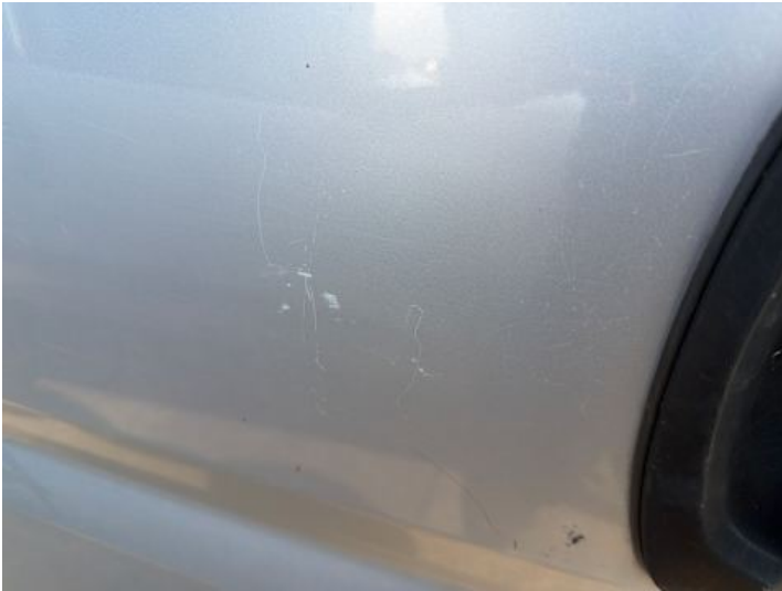
Türe hinten rechts (Kratzer, Lackschaden)
