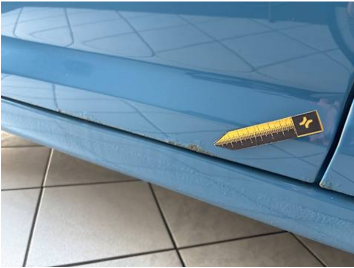
Türe hinten rechts (Rost)
