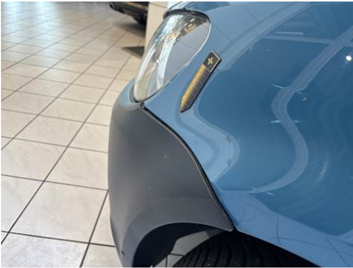
Stoßstange vorne (Spaltmaße ungenau)
