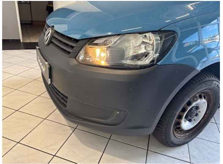
Stoßstange vorne (Spaltmaße ungenau)
