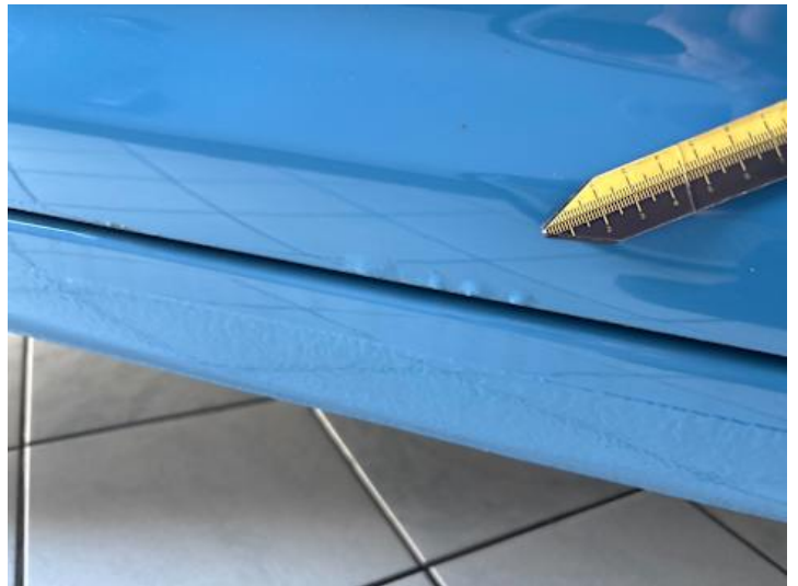
Türe hinten rechts (Rost)
