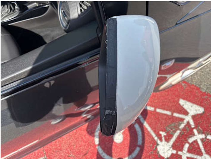
Beifahrertür (Unsachgemäß instand gesetzt, Riss/Bruch)
