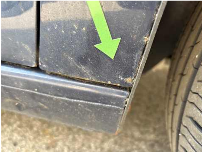
Kotflügel vorne rechts (Rost)
