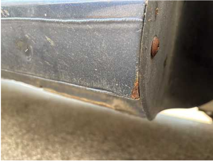
Schweller rechts (Rost)
