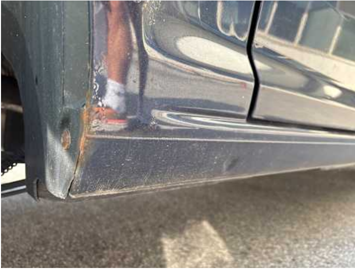
Schweller rechts (Rost)
