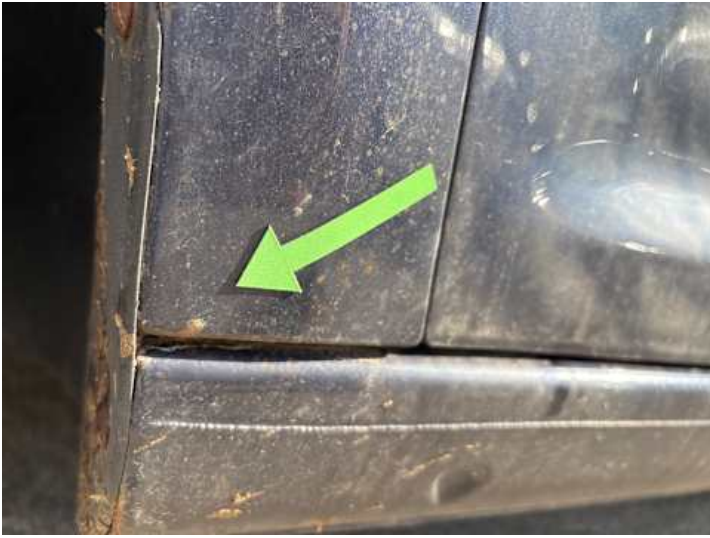
Kotflügel vorne links (Rost)
