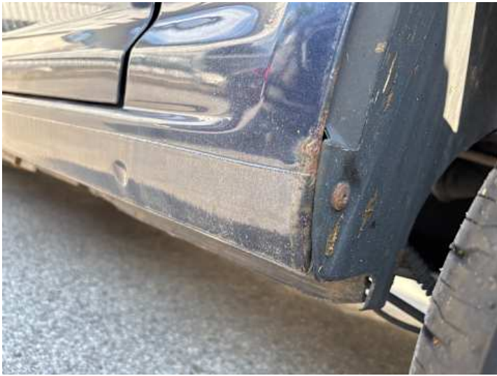
Schweller links (Rost)
