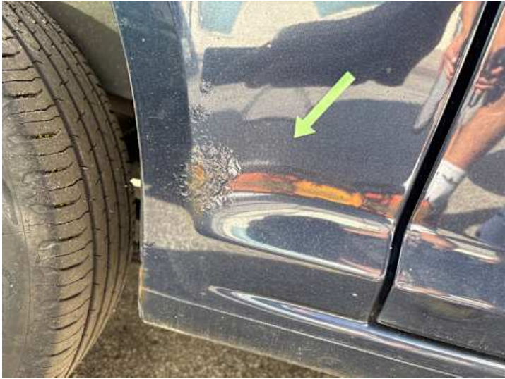
Seitenteil hinten rechts (Rost)
