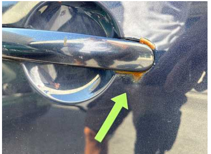
Türe hinten rechts (Rost)
