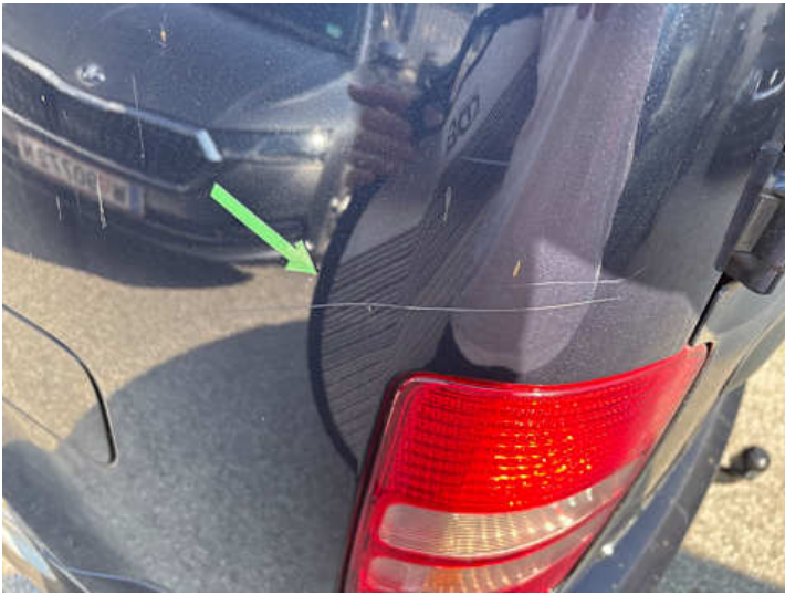
Seitenteil hinten links (Kratzer)
