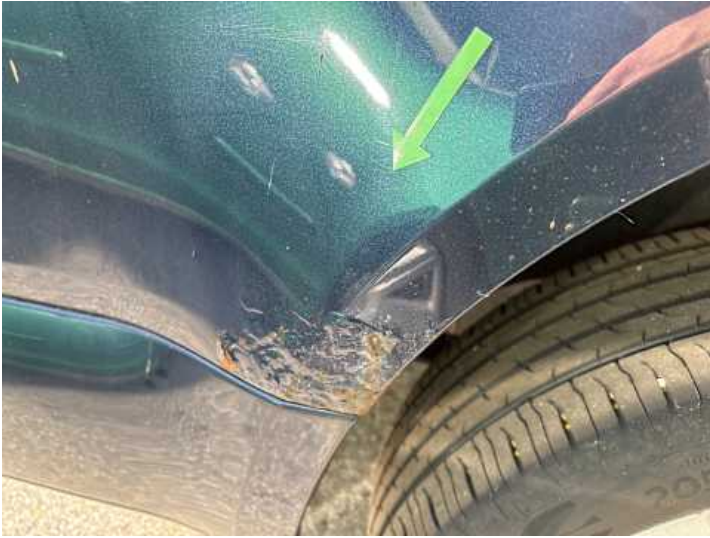
Seitenteil hinten rechts (Rost)
