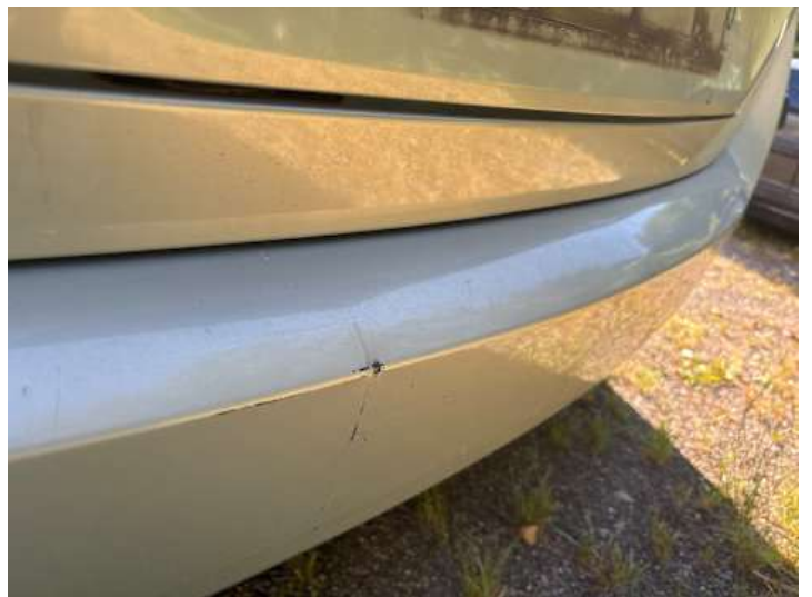
Stoßstange hinten (Unsachgemäß instand gesetzt, Lackschaden)
