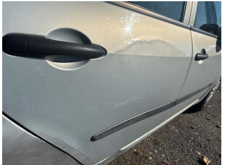
Türe hinten rechts (Verformung, Lackschaden)
