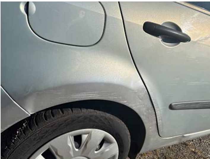
Seitenteil hinten rechts (Unsachgemäß instand gesetzt, Verformung)
