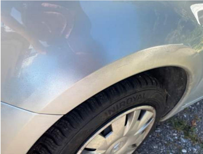
Kotflügel vorne links (Ausgeblichen/Matt, Unsachgemäß instand gesetzt)
