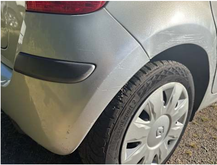
Stoßstange hinten (Unsachgemäß instand gesetzt, Lackschaden)
