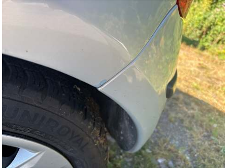
Seitenteil hinten links (Lackschaden)
