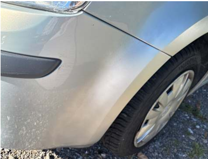
Stoßstange vorne (Unsachgemäß instand gesetzt, Ausgeblichen/Matt)
