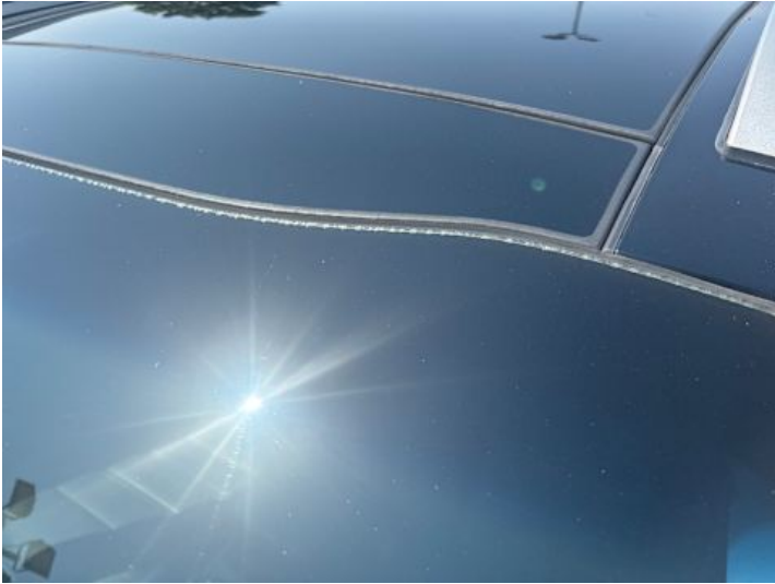
Windschutzscheibe (Anderer Schaden): Kleber löst sich
