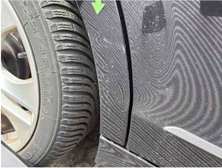
Seitenteil hinten rechts (Verformung, Lackschaden)
