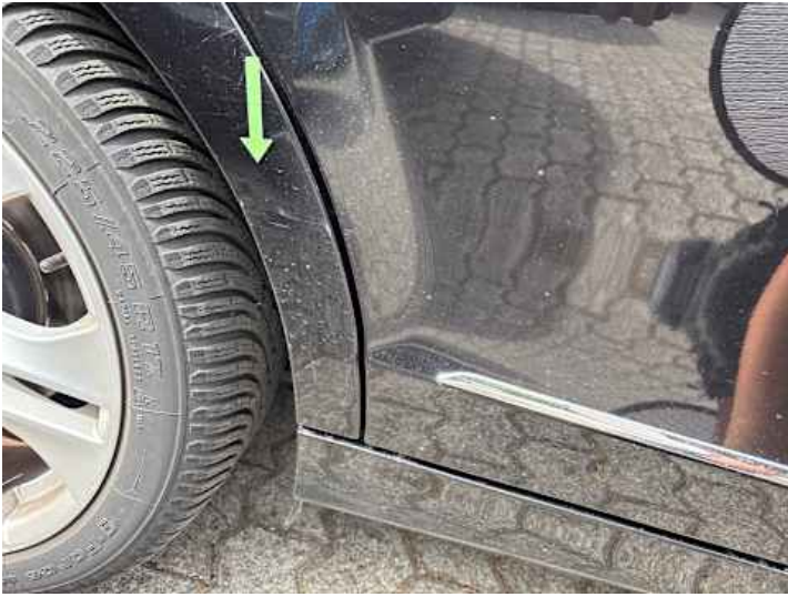
Seitenteil hinten rechts (Verformung, Lackschaden)
