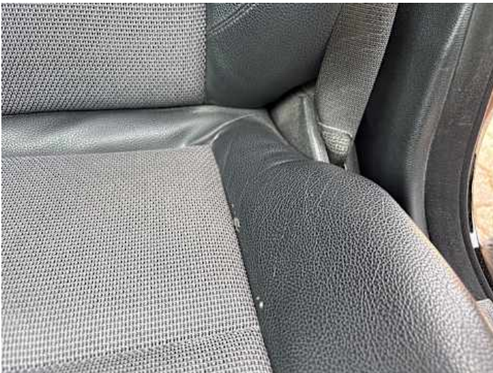
Innenraum (Verschleiß, Riss/Bruch)
