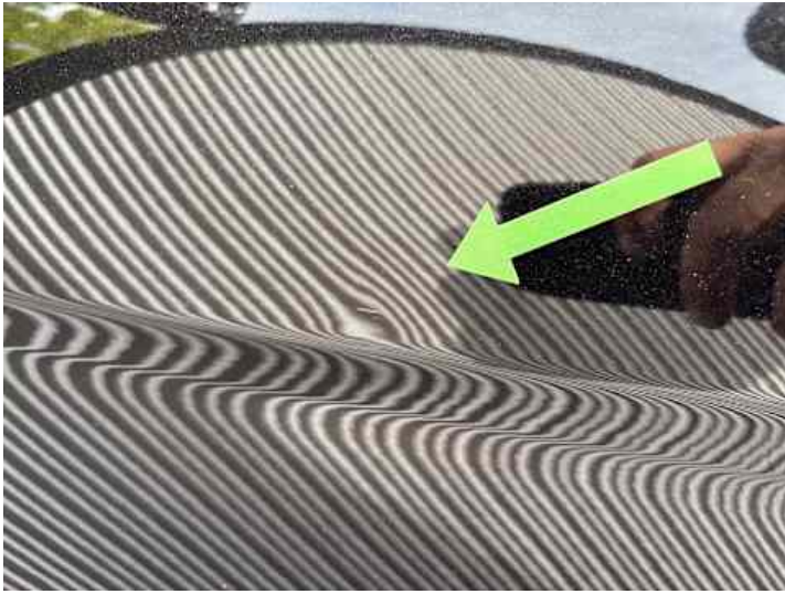
Fahrtür (Delle, Kratzer)
