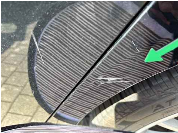
Seitenteil hinten links (Kratzer, Verformung)
