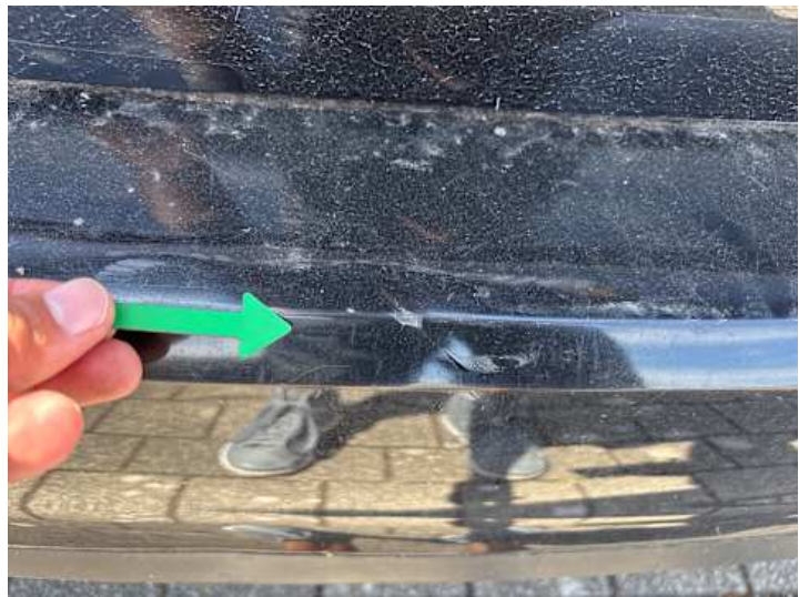
Stoßstange hinten (Verformung, Kratzer)
