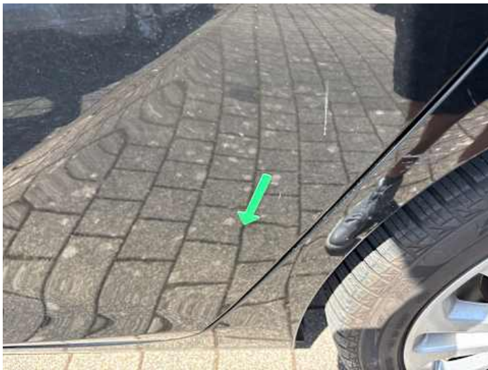
Türe hinten links (Verformung)
