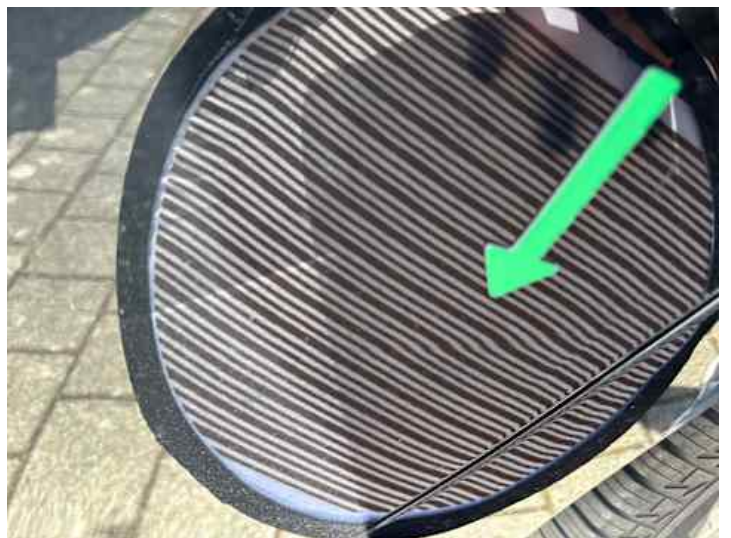
Türe hinten links (Verformung)
