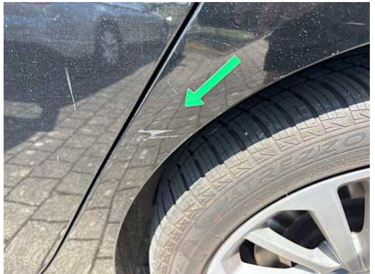
Seitenteil hinten links (Kratzer, Verformung)
