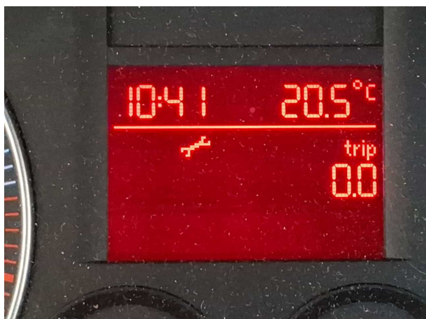
Beschädigung #2: Sonstiges: Inspektion/Wartung - fällig - erneuern
