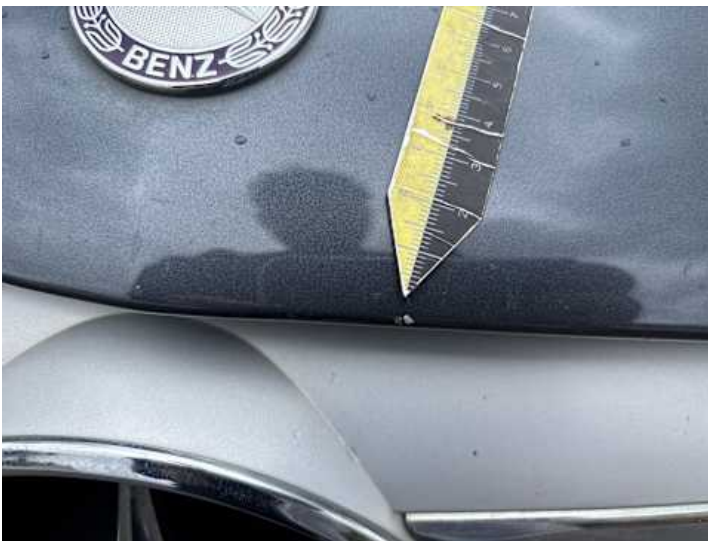
Motorhaube (Steinschlag, Unsachgemäß instand gesetzt, Rost)
