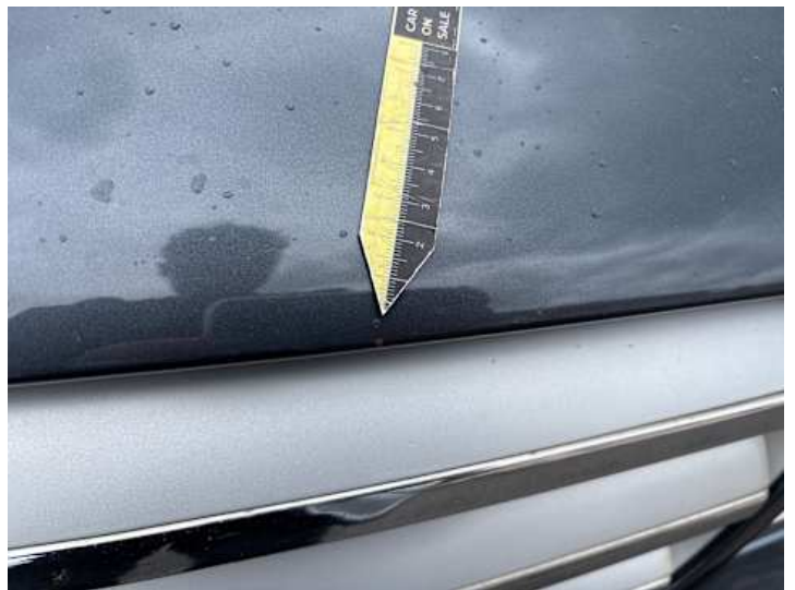
Motorhaube (Steinschlag, Unsachgemäß instand gesetzt, Rost)
