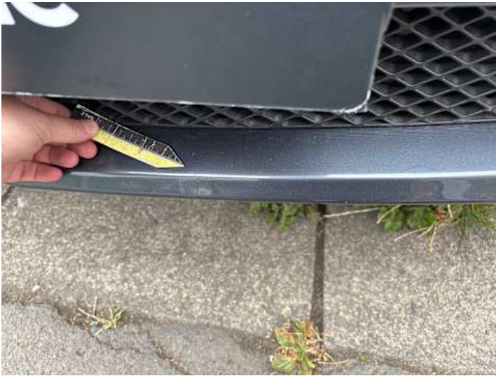
Stoßstange vorne (Riss/Bruch, Verformung)
