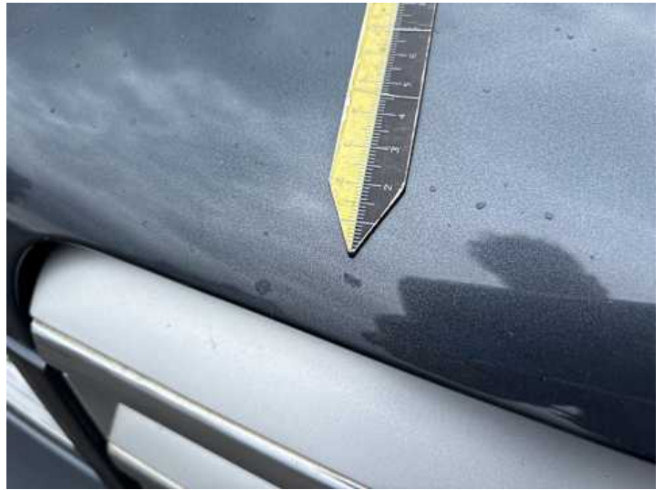
Motorhaube (Steinschlag, Unsachgemäß instand gesetzt, Rost)
