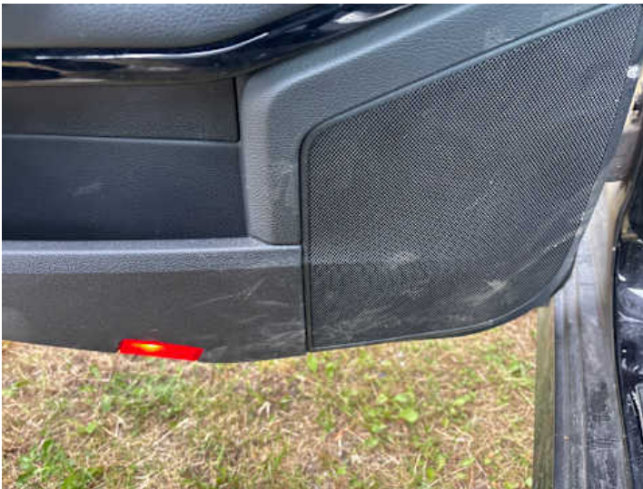
Innenraum (Verschleiß, Kratzer, Verschmutzung)
