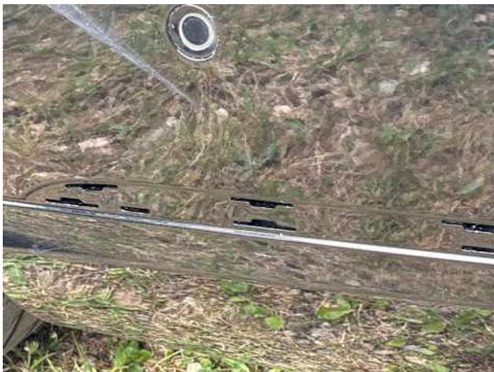
Stoßstange hinten (Riss/Bruch, Anderer Schaden): Zierleiste fehlt
