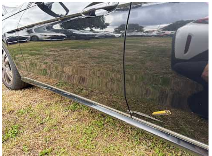
Türe hinten links (Kratzer, Lackschaden, Verformung)
