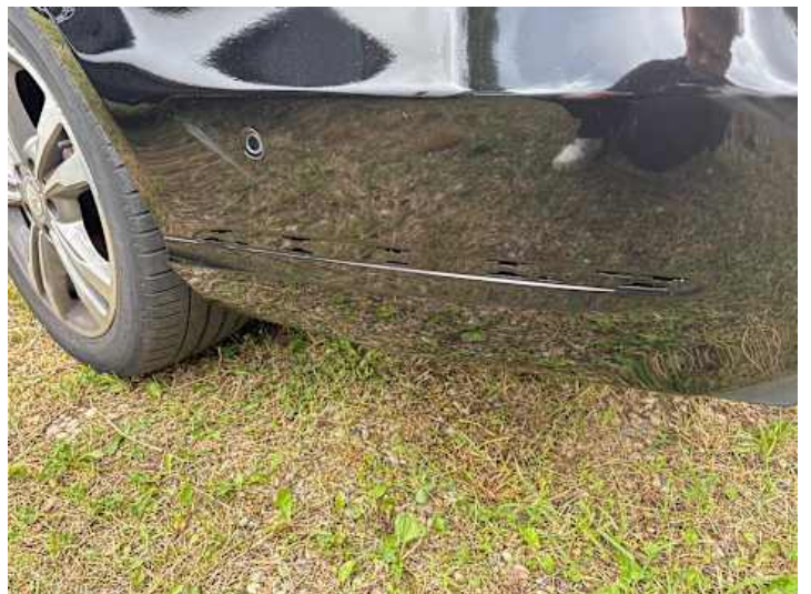
Stoßstange hinten (Riss/Bruch, Anderer Schaden): Zierleiste fehlt
