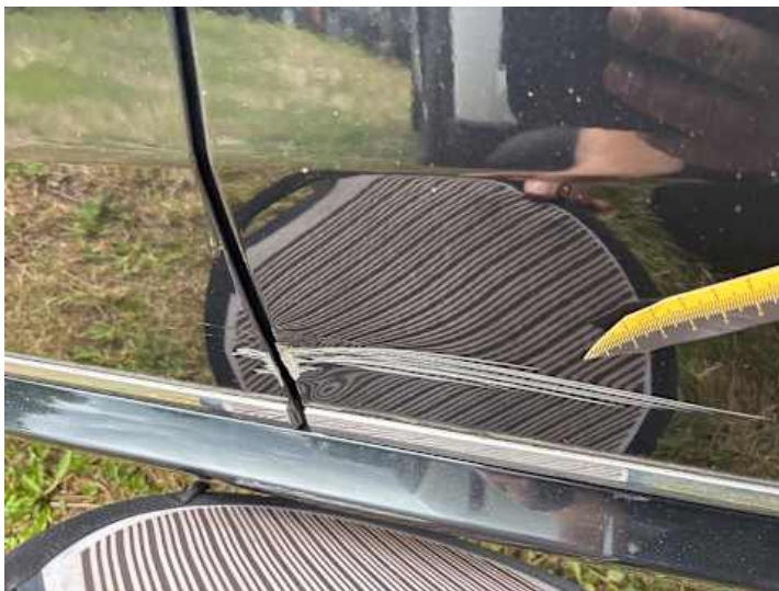
Türe hinten links (Kratzer, Lackschaden, Verformung)
