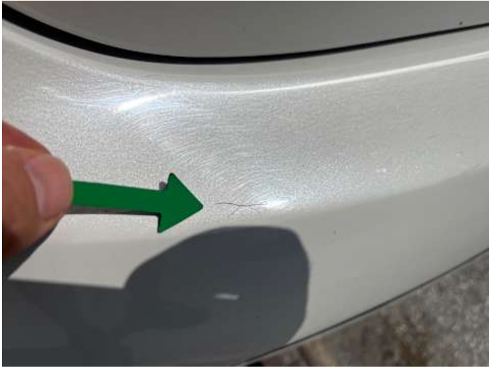
Stoßstange hinten (Lackschaden)
