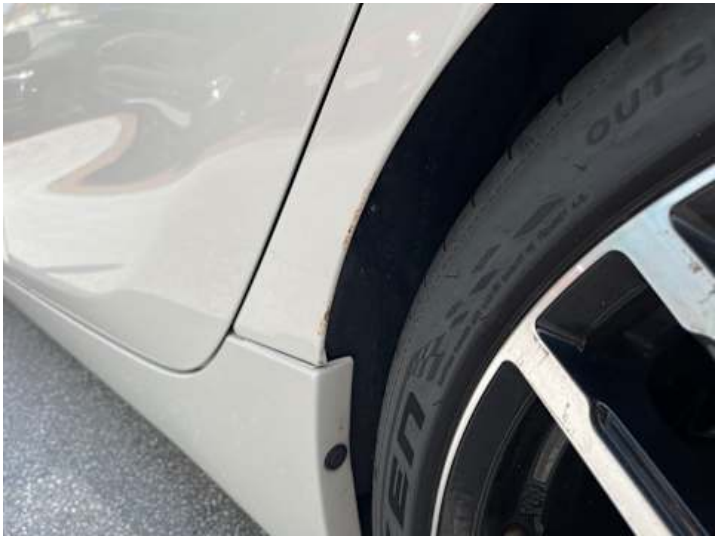
Seitenteil hinten links (Rost)
