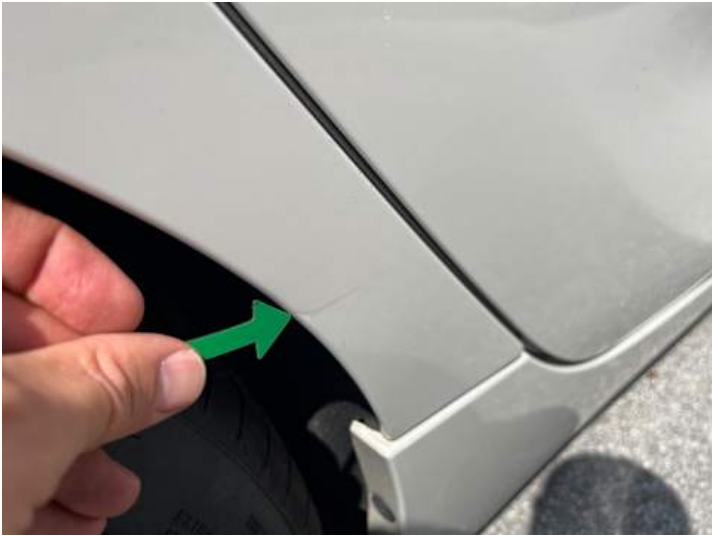
Seitenteil hinten rechts (Lackschaden)
