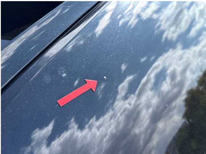
Seitenteil hinten rechts (Lackschaden)
