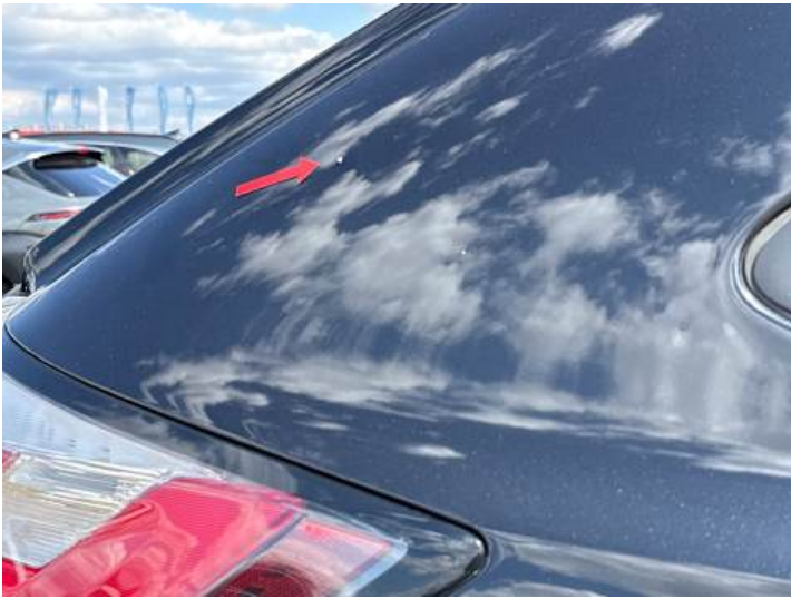
Seitenteil hinten rechts (Lackschaden)
