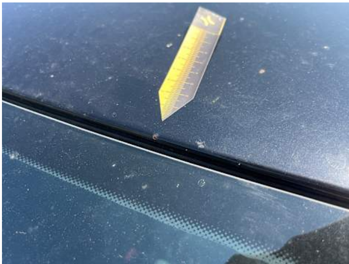
Dach (Steinschlag, Lackschaden)
