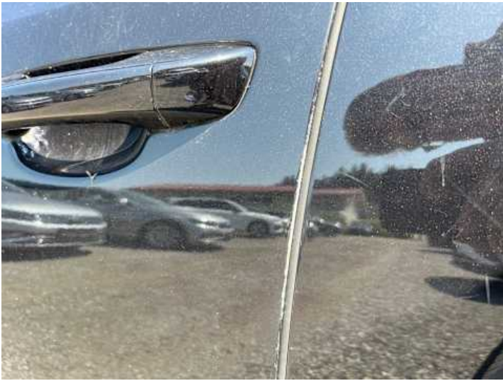
Fahrertür (Lackschaden, Verformung, Delle)
