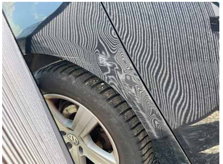
Seitenteil hinten rechts (Lackschaden, Kratzer, Verformung)
