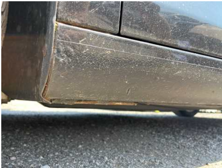
Schweller links (Rost, Lackschaden)
