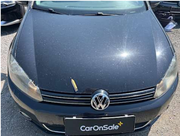
Motorhaube (Lackschaden, Steinschlag)
