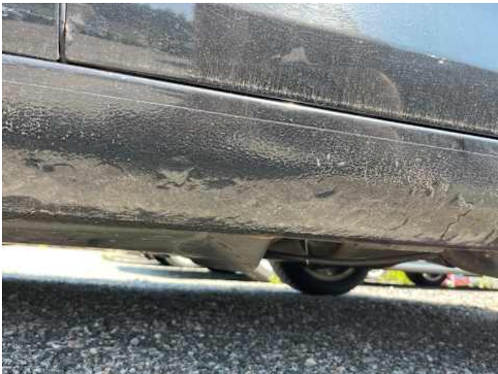
Schweller links (Rost, Lackschaden)
