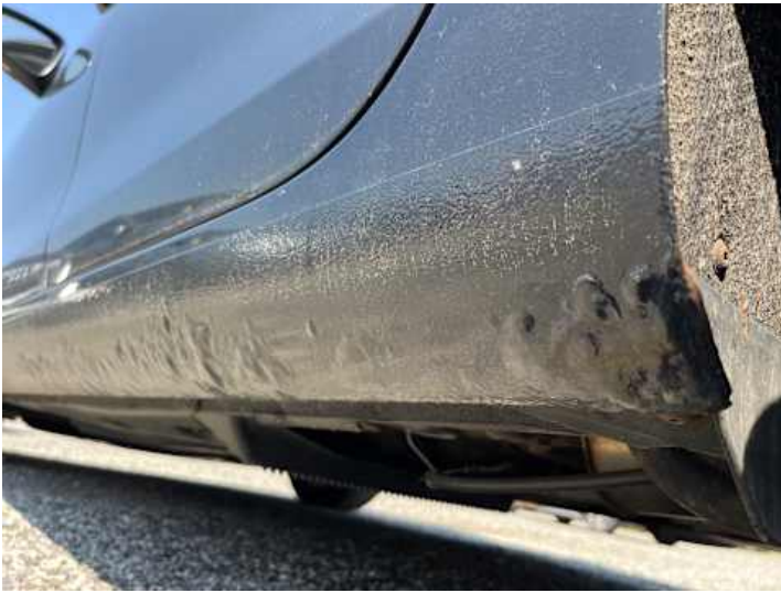
Schweller links (Rost, Lackschaden)
