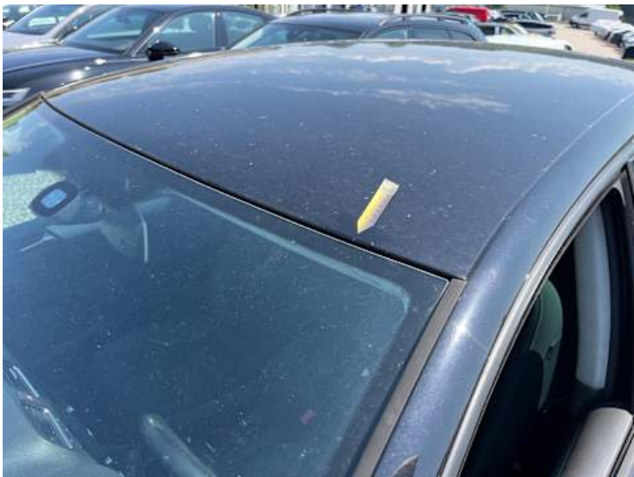
Dach (Steinschlag, Lackschaden)
