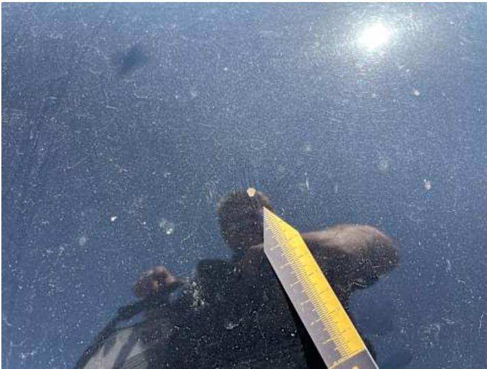
Motorhaube (Lackschaden, Steinschlag)
