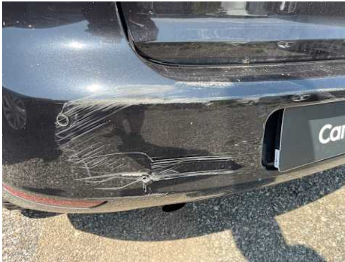
Stoßstange hinten (Kratzer, Lackschaden, Riss/Bruch)
