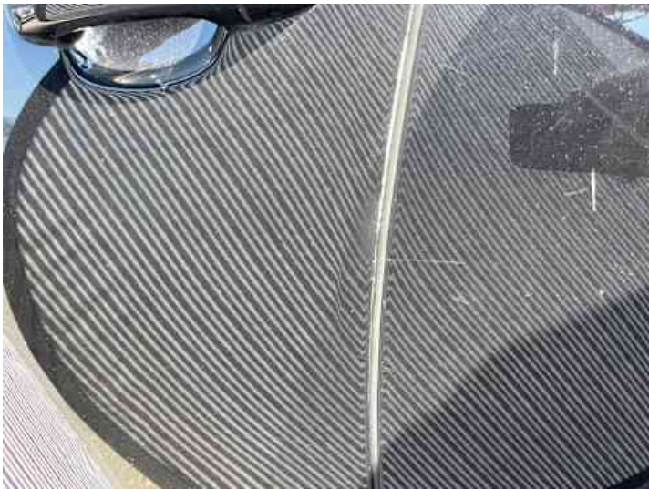
Fahrertür (Lackschaden, Verformung, Delle)
