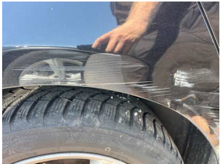
Seitenteil hinten rechts (Lackschaden, Kratzer, Verformung)
