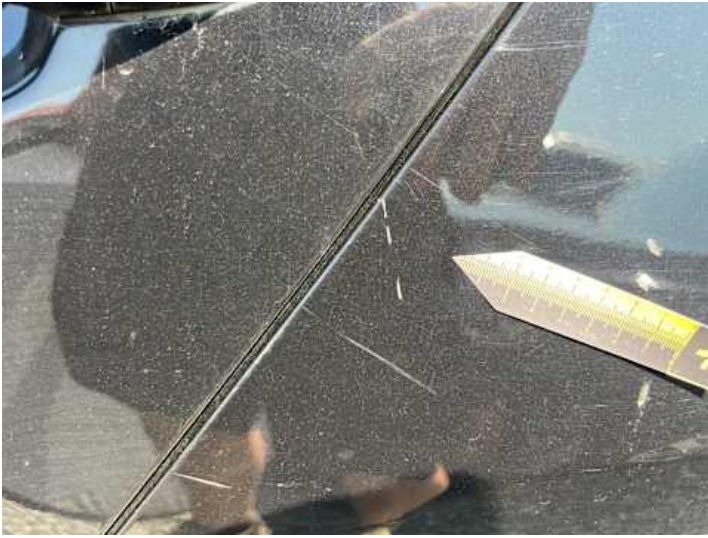
Seitenteil hinten links (Kratzer, Lackschaden)
