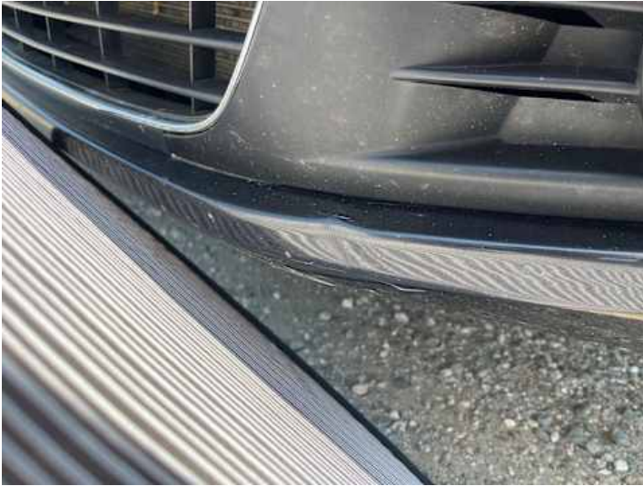
Stoßstange vorne (Verformung)
