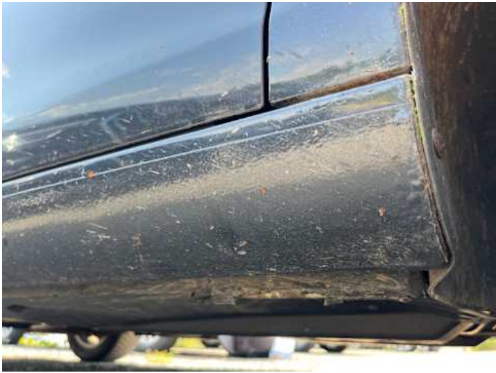
Schweller rechts (Rost, Lackschaden)
