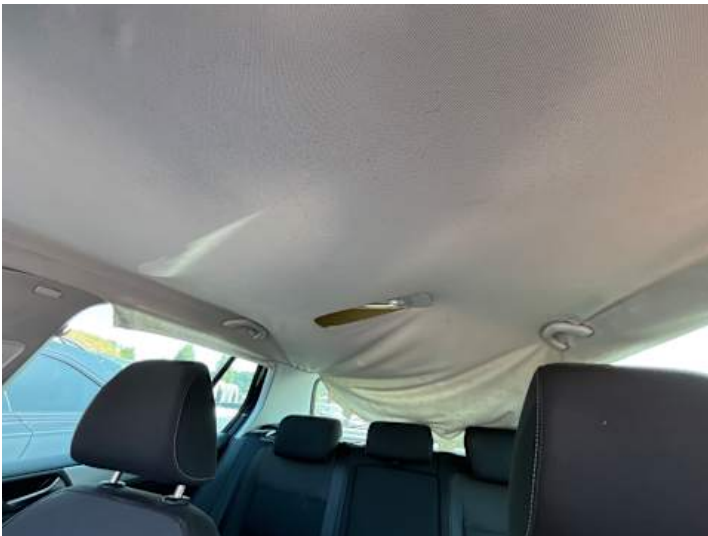
Innenraum (Anderer Schaden): Dachhimmel hängt;
