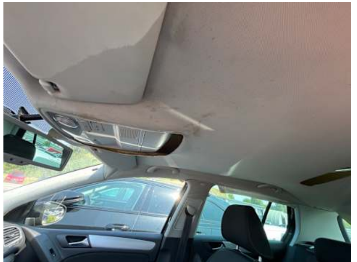
Innenraum (Anderer Schaden): Dachhimmel hängt;
