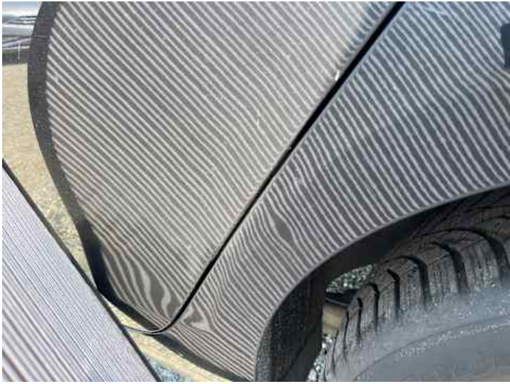
Seitenteil hinten links (Kratzer, Lackschaden)
