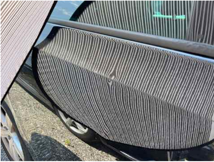
Türe hinten rechts (Kratzer, Verformung)
