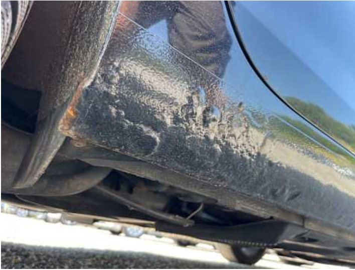
Schweller rechts (Rost, Lackschaden)
