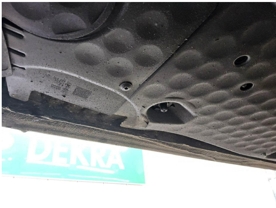
Bild 20 : Unterbodenverkleidung gebrochen, Minderwert
