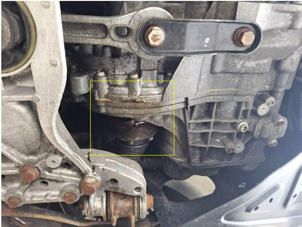
Bild 15 : Getriebe ungeklärter Ölverlust, prüfen und nach Befund instandsetzen. Kostenerweiterung möglich!
