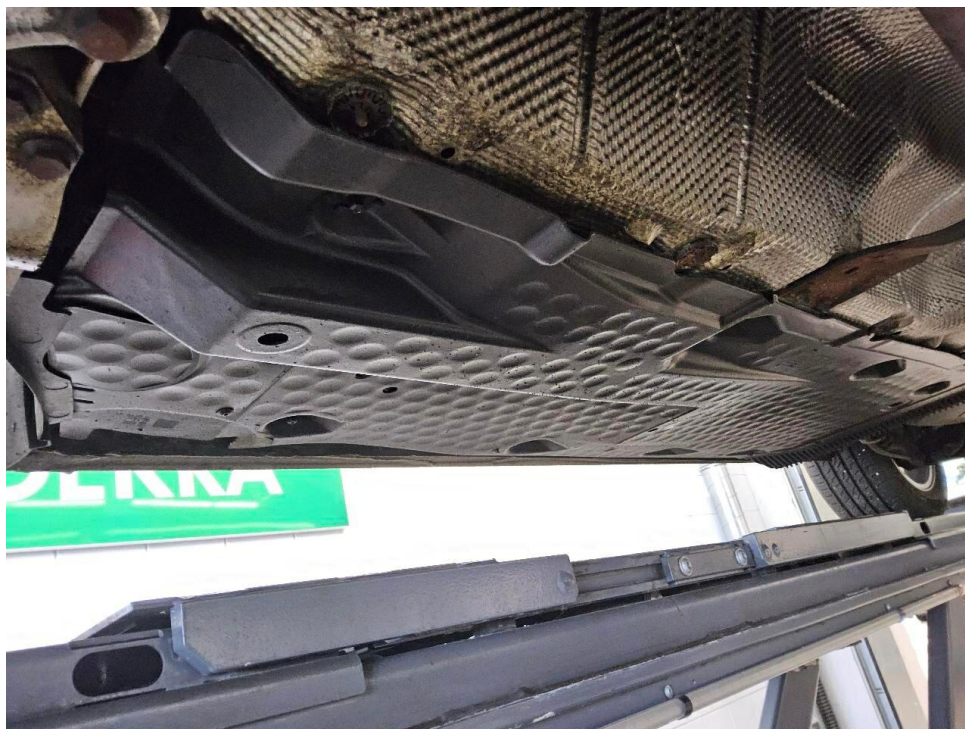
Bild 19 : Unterbodenverkleidung gebrochen, Minderwert
