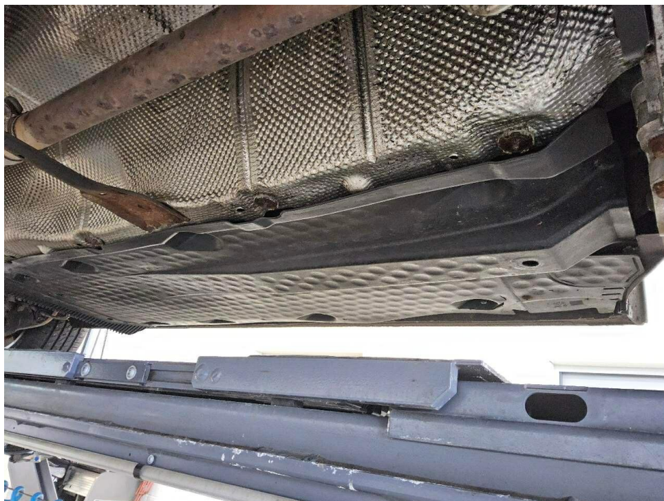
Bild 17 : Unterbodenverkleidung gebrochen, Minderwert
