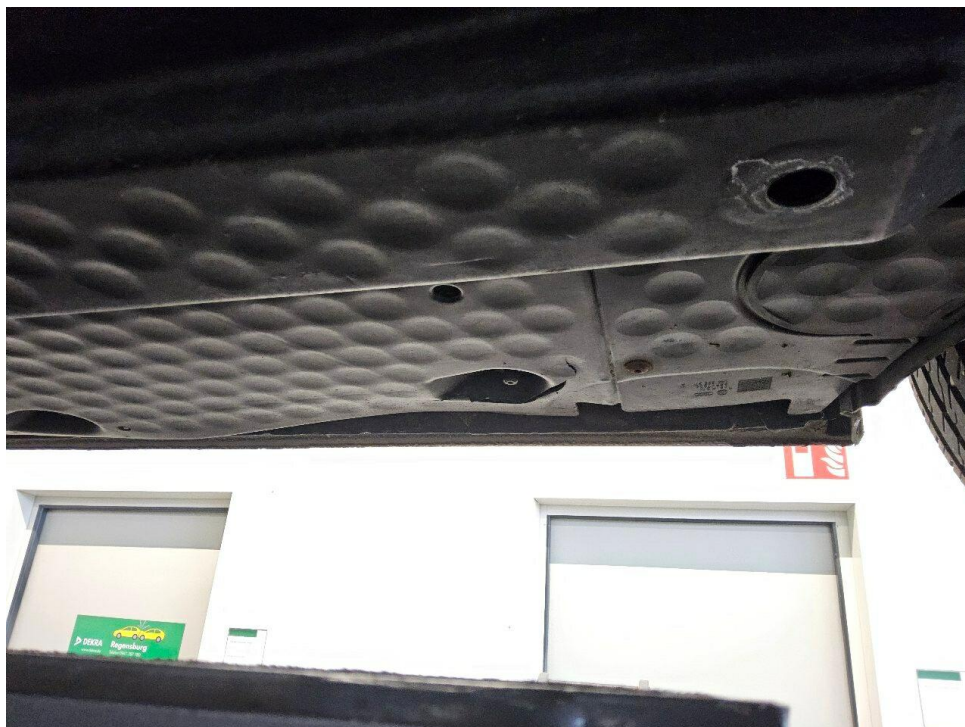
Bild 18 : Unterbodenverkleidung gebrochen, Minderwert
