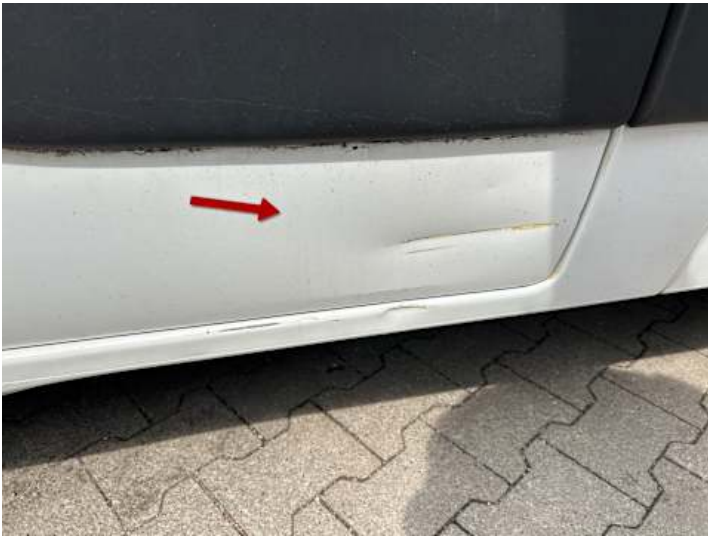
Fahrerseite (Delle, Kratzer)
