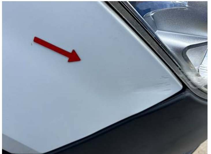
Kotflügel vorne rechts (Kratzer, Delle)
