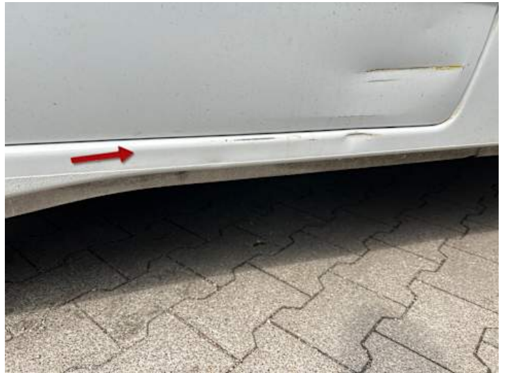
Schweller links (Kratzer, Delle)
