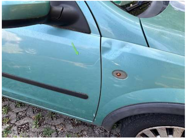
Beifahrertür (Kratzer, Delle)
