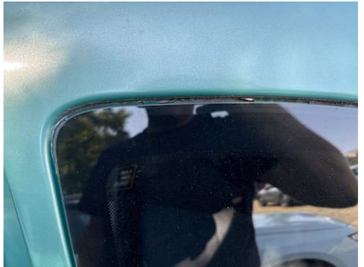
Seitenteil hinten links (Lackschaden)
