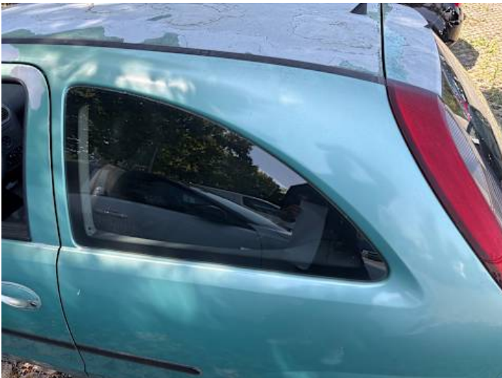
Seitenteil hinten links (Lackschaden)
