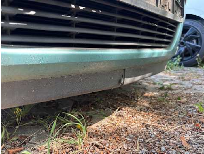
Stoßstange vorne (Riss/Bruch)
