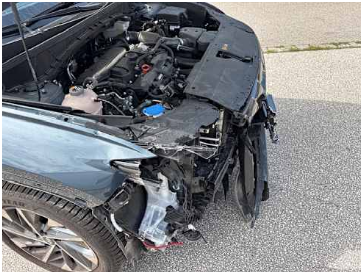
Stoßstange vorne (Riss/Bruch)
