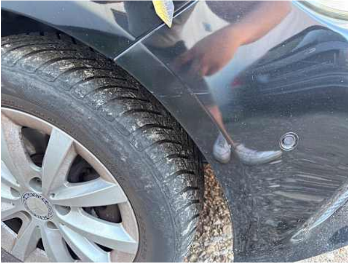
Stoßstange vorne (Lackschaden, Unsachgemäß instand gesetzt)
