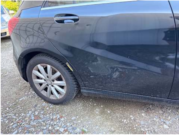
Seitenteil hinten rechts (Delle, Lackschaden)
