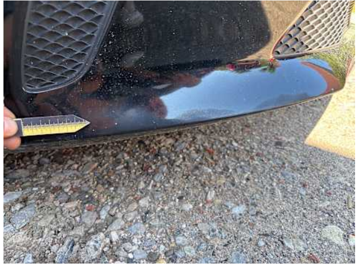
Stoßstange vorne (Lackschaden, Unsachgemäß instand gesetzt)
