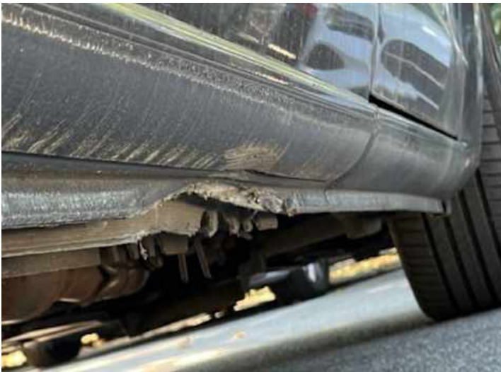
Schweller rechts (Verformung, Delle)
