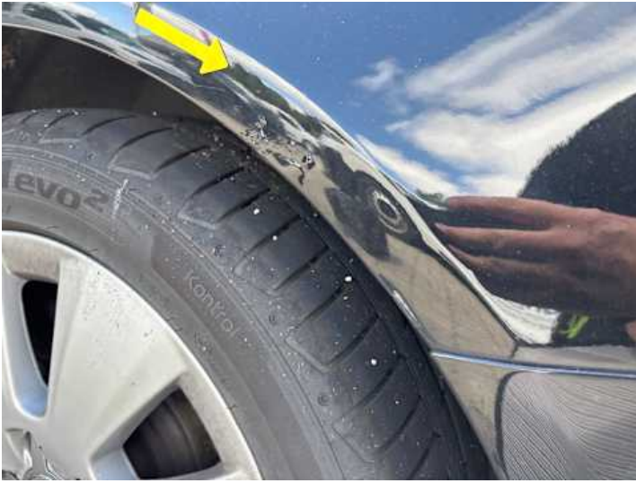
Seitenteil hinten links (Rost, Lackschaden)
