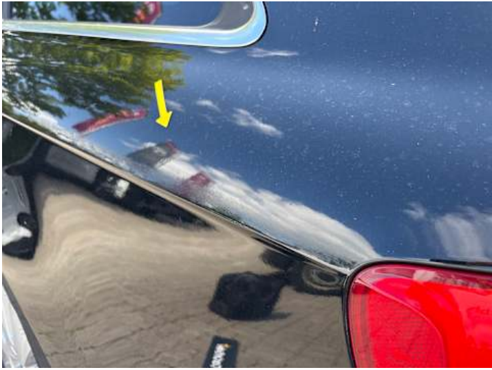
Seitenteil hinten links (Unsachgemäß instand gesetzt)
