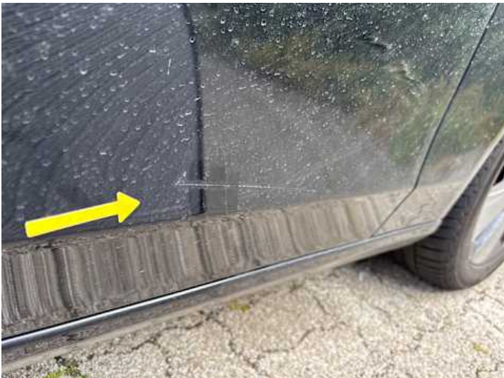
Beifahrertür (Lackschaden, Kratzer)
