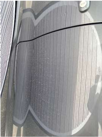
Türe hinten links (Delle)
