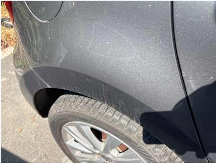
Seitenteil hinten rechts (Kratzer)
