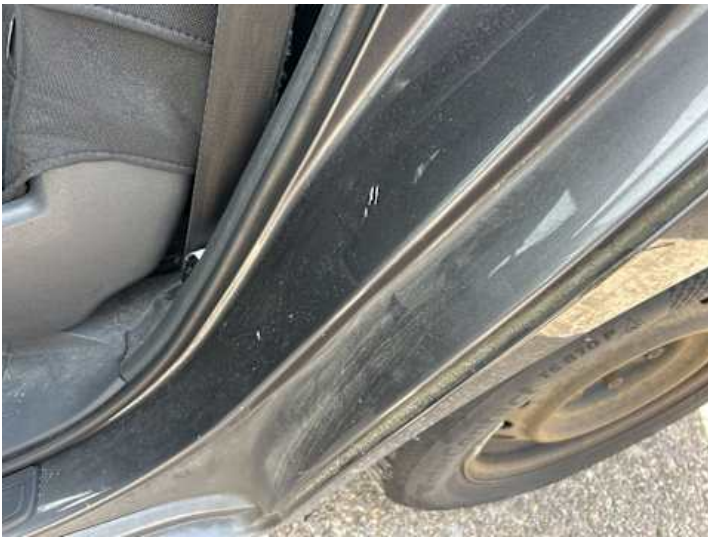
Schweller rechts (Kratzer, Delle)
