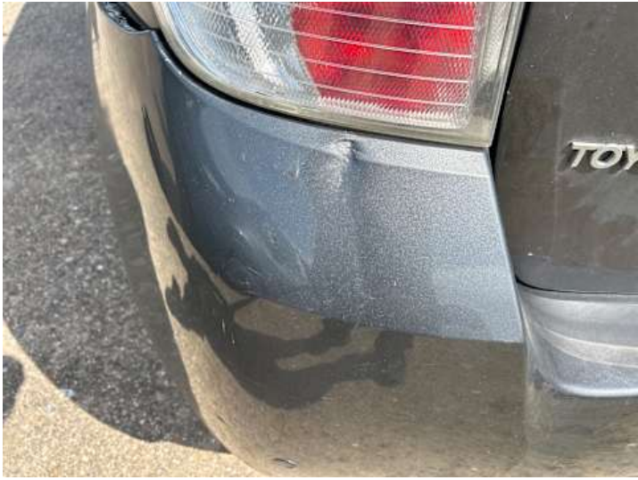
Stoßstange hinten (Riss/Bruch)
