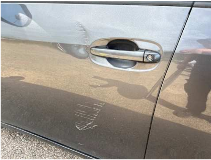
Fahrtür (Kratzer, Verformung)
