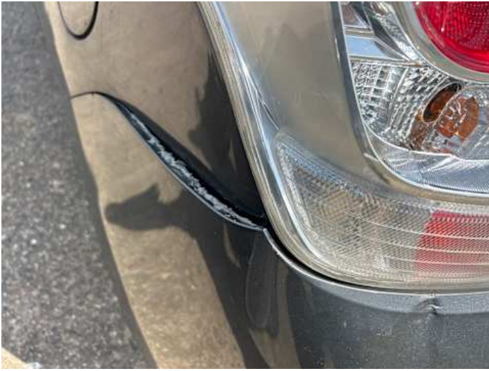
Stoßstange hinten (Riss/Bruch)
