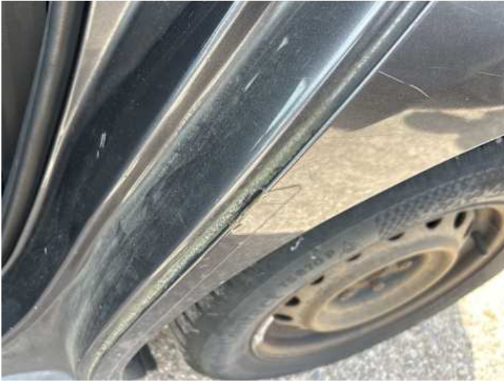
Seitenteil hinten links (Rost)
