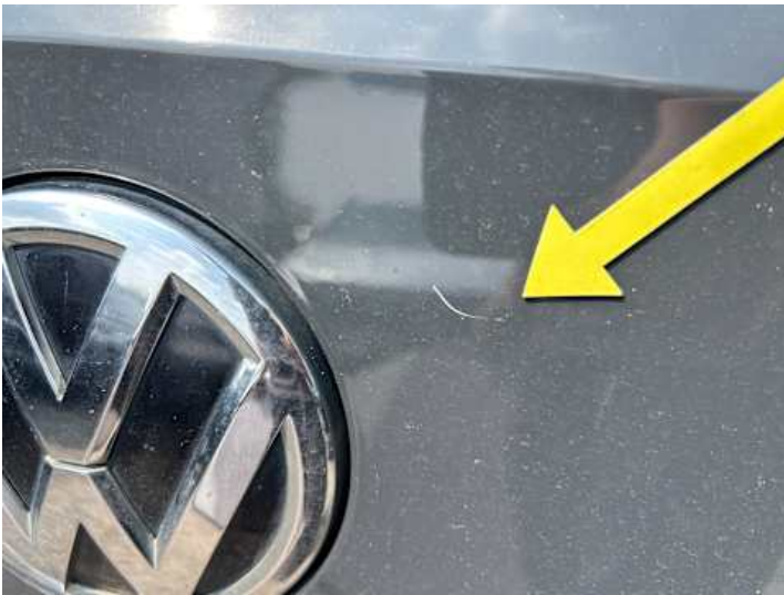
Heckklappe (Lackschaden, Kratzer)
