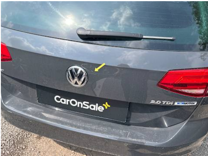
Heckklappe (Lackschaden, Kratzer)
