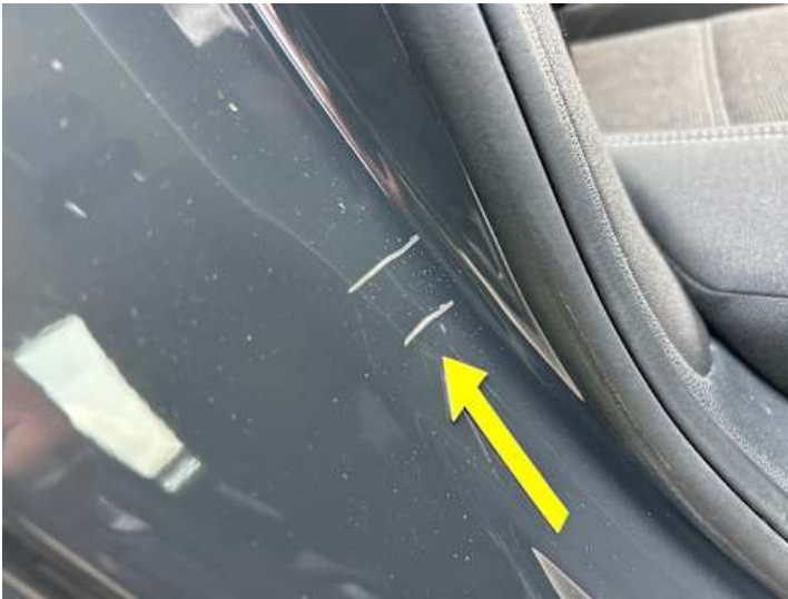
Seitenteil hinten rechts (Lackschaden)
