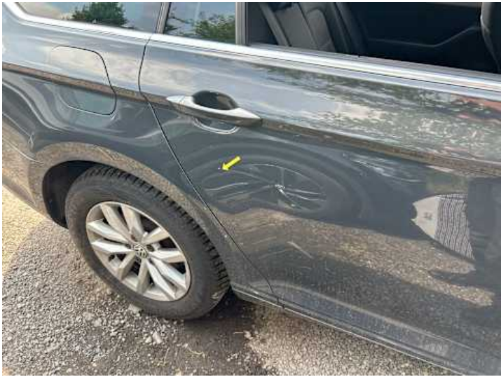
Türe hinten rechts (Lackschaden, Delle)
