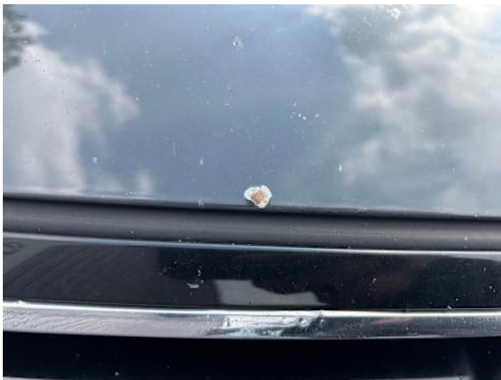
Motorhaube (Lackschaden, Steinschlag)
