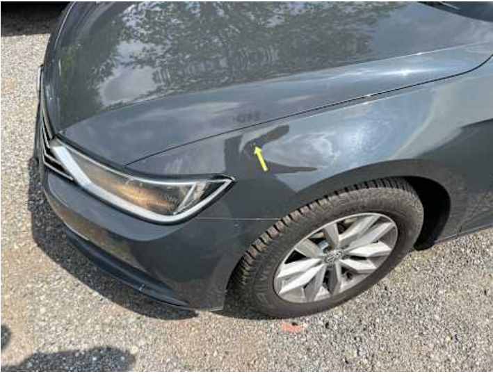
Kotflügel vorne links (Lackschaden, Steinschlag)
