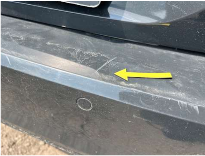
Stoßstange hinten (Kratzer, Lackschaden)
