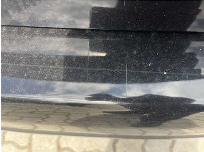
Stoßstange hinten (Kratzer, Lackschaden)
