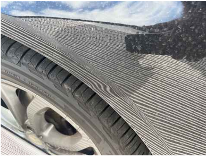
Kotflügel vorne links (Delle)
