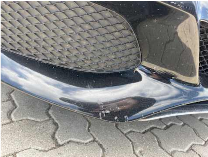
Stoßstange vorne (Lackschaden)
