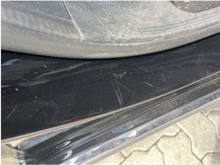
Türe hinten rechts (Kratzer, Lackschaden)
