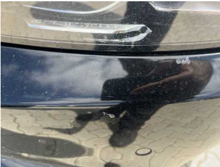
Stoßstange vorne (Lackschaden)
