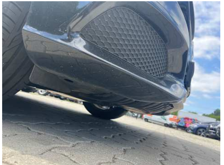
Stoßstange vorne (Kratzer, Lackschaden)
