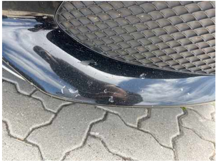
Stoßstange vorne (Lackschaden)
