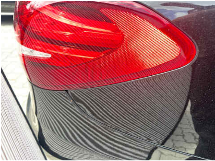
Seitenteil hinten rechts (Delle)
