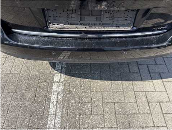
Stoßstange hinten (Kratzer, Lackschaden)
