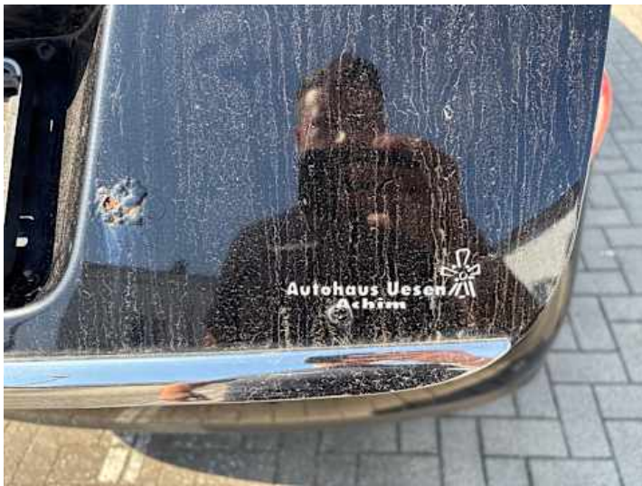
Heckklappe (Rost, Lackschaden, Delle)
