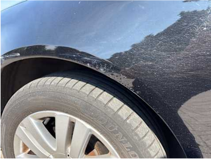
Kotflügel vorne links (Verformung, Rost, Riss/Bruch)
