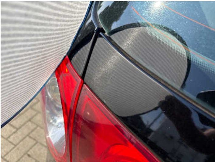
Heckklappe (Rost, Lackschaden, Delle)
