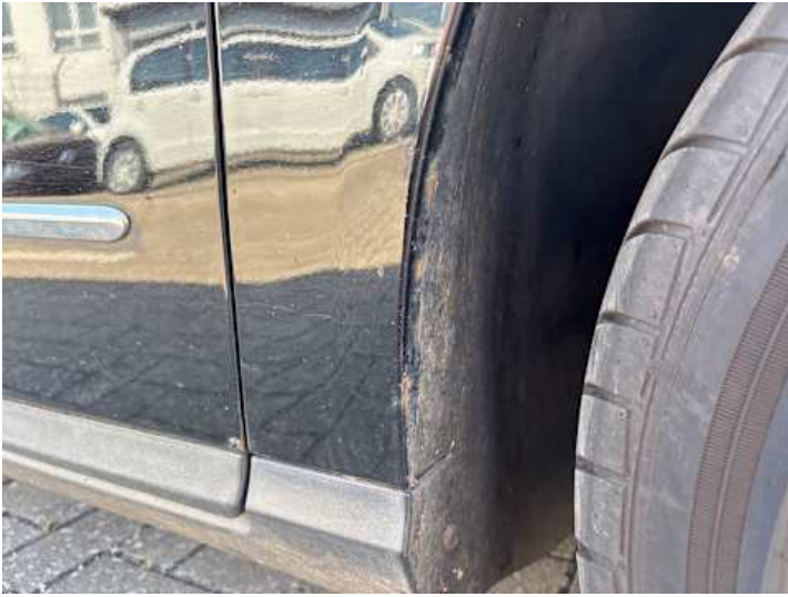
Kotflügel vorne rechts (Rost, Lackschaden, Delle, Kratzer)
