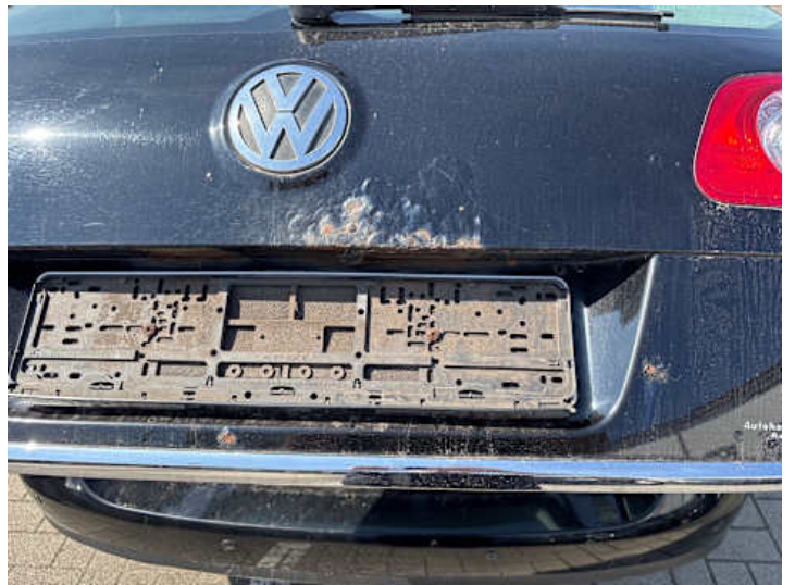
Heckklappe (Rost, Lackschaden, Delle)
