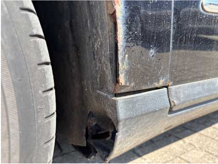
Kotflügel vorne links (Verformung, Rost, Riss/Bruch)
