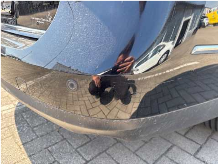
Stoßstange hinten (Kratzer, Lackschaden)
