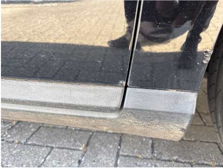
Beifahrertür (Kratzer, Lackschaden, Rost)
