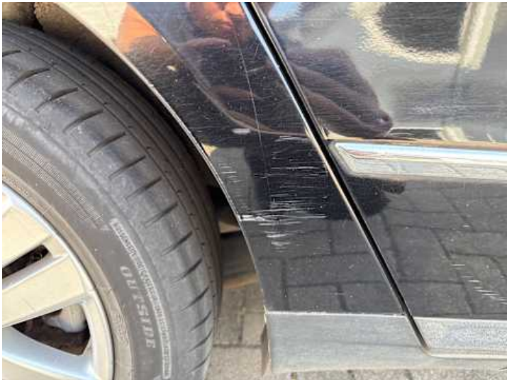
Seitenteil hinten rechts (Rost, Kratzer, Lackschaden)
