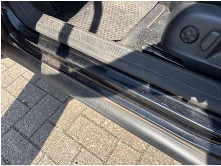
Schweller links (Kratzer, Riss/Bruch)
