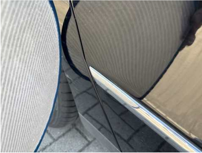
Türe hinten rechts (Kratzer, Lackschaden, Delle)
