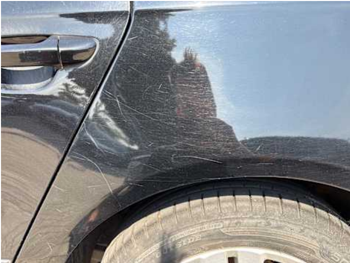
Seitenteil hinten links (Kratzer, Lackschaden, Rost)
