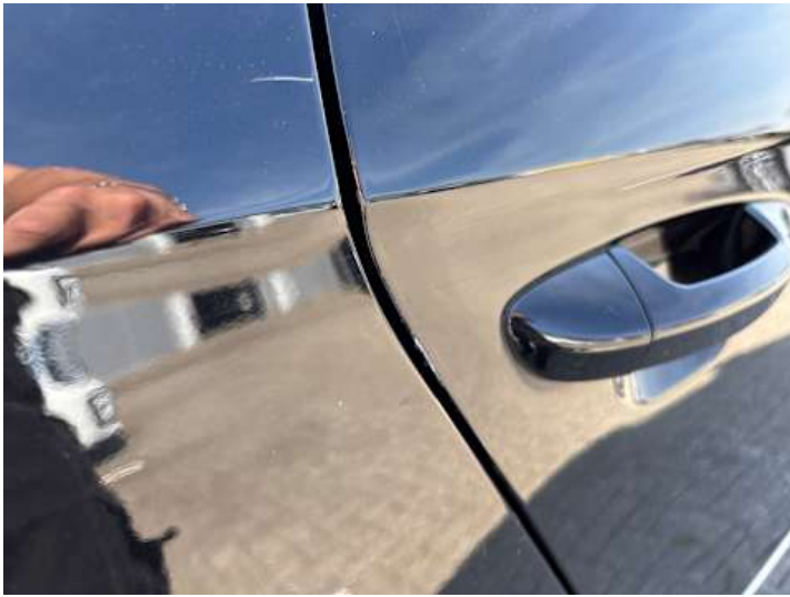
Türe hinten rechts (Kratzer, Lackschaden, Delle)
