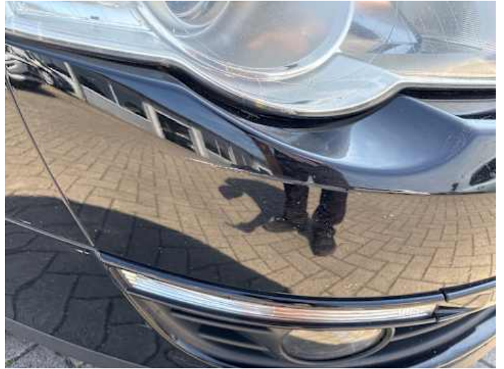
Stoßstange vorne (Lackschaden, Kratzer)
