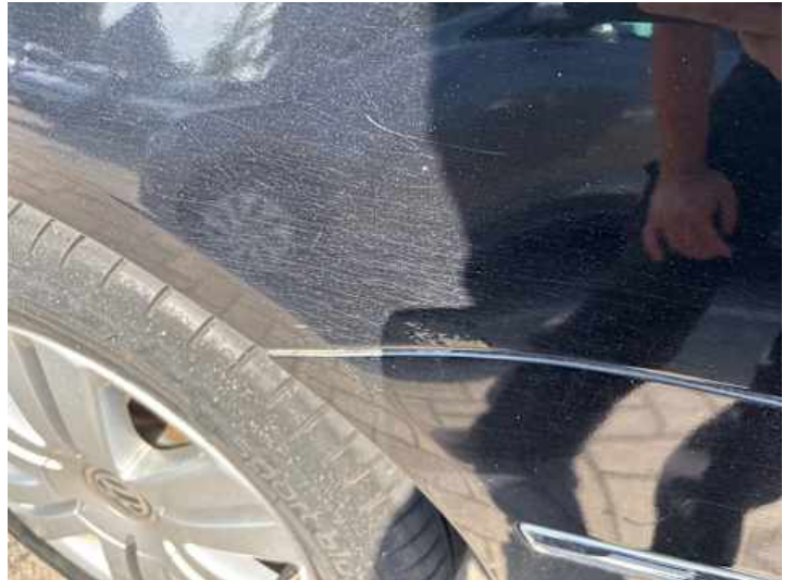
Seitenteil hinten links (Kratzer, Lackschaden, Rost)
