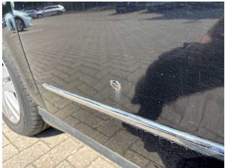
Fahrtür (Lackschaden, Kratzer, Rost, Delle, Riss/Bruch)
