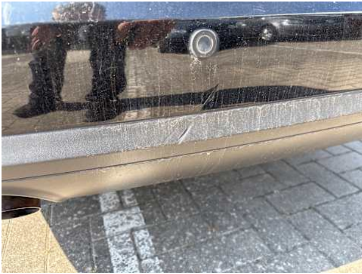
Stoßstange hinten (Kratzer, Lackschaden)
