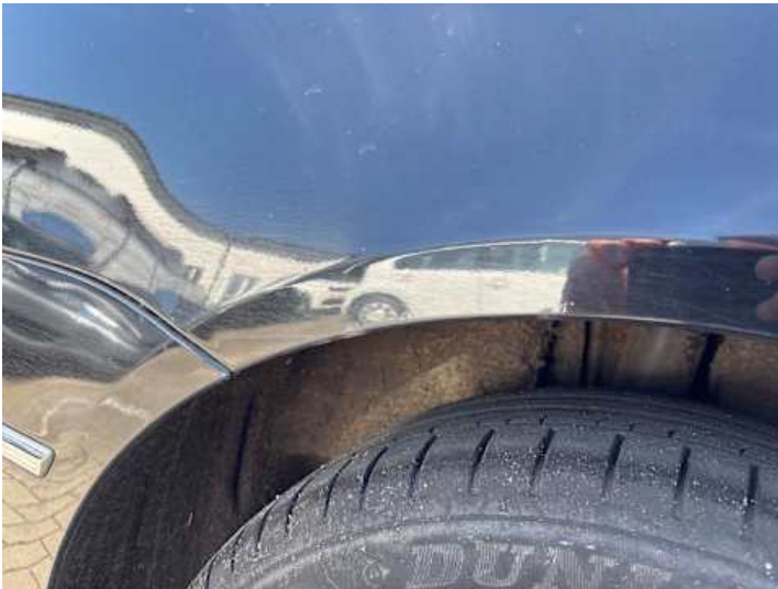
Seitenteil hinten rechts (Rost, Kratzer, Lackschaden)
