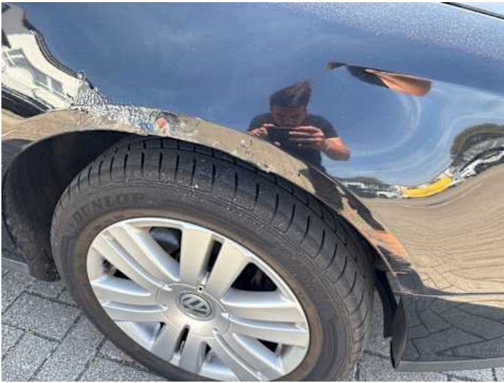
Kotflügel vorne rechts (Rost, Lackschaden, Delle, Kratzer)
