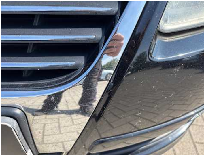
Stoßstange vorne (Lackschaden, Kratzer)
