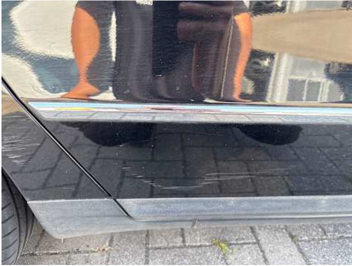
Türe hinten rechts (Kratzer, Lackschaden, Delle)
