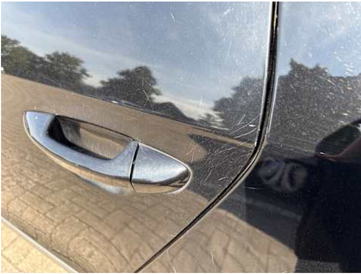
Türe hinten links (Lackschaden, Kratzer)
