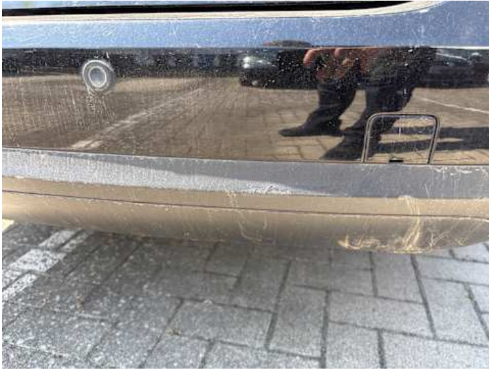
Stoßstange hinten (Kratzer, Lackschaden)
