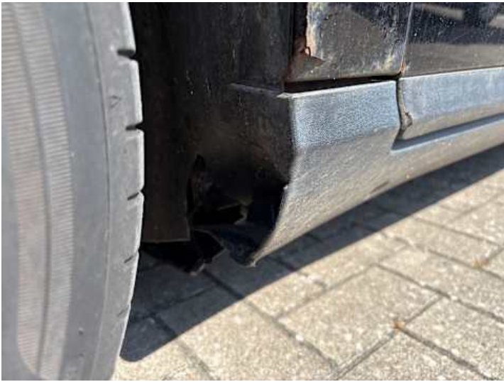
Schweller links (Kratzer, Riss/Bruch)
