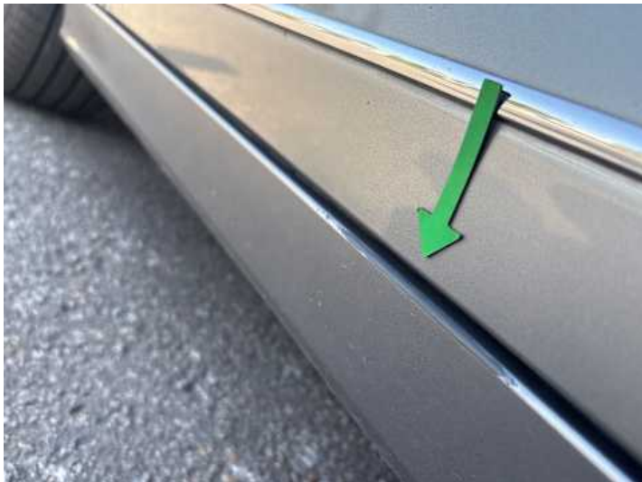
Schweller links (Lackschaden)
