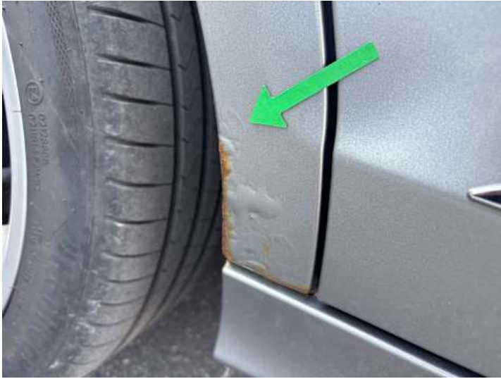
Seitenteil hinten rechts (Rost)
