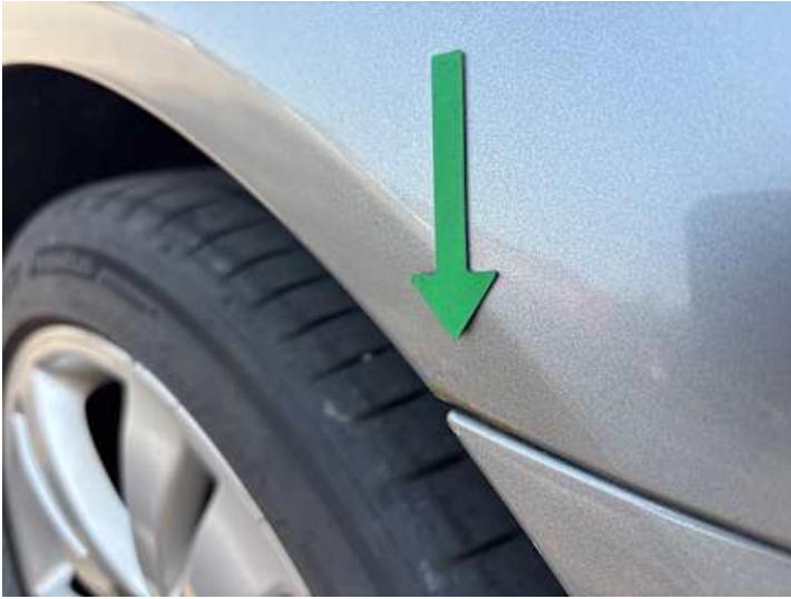
Seitenteil hinten links (Rost)
