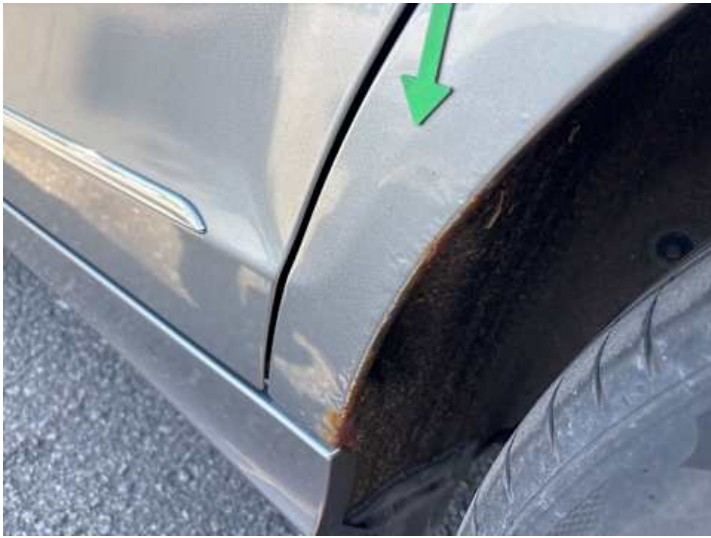
Seitenteil hinten links (Rost)
