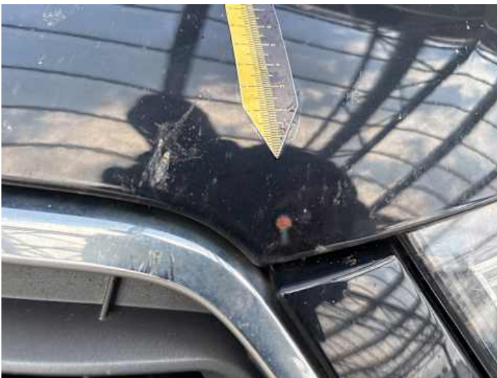
Motorhaube (Rost, Steinschlag)
