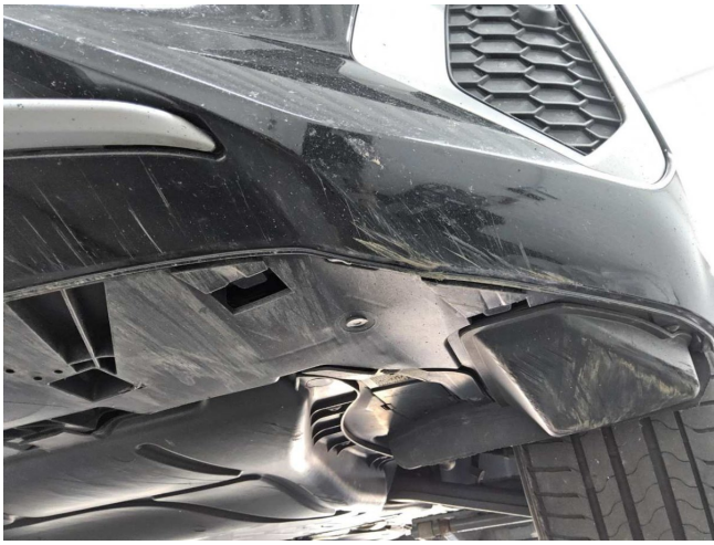
Stoßfänger vorne Lackierung, zerkratzt, smart repair (DEKRA)
