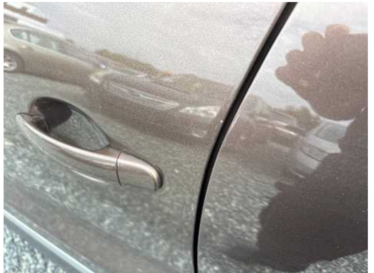
Fahrtür (Lackschaden, Kratzer)
