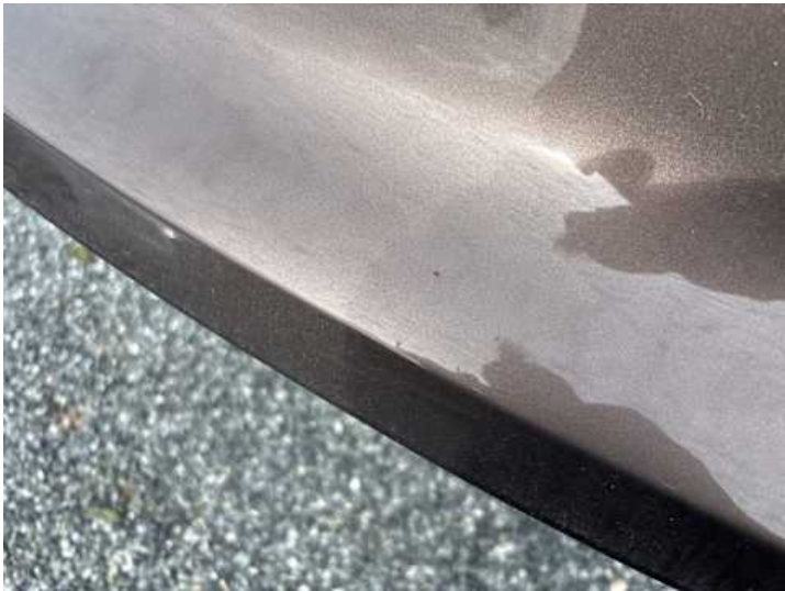
Heckklappe (Unsachgemäß instand gesetzt, Lackschaden)
