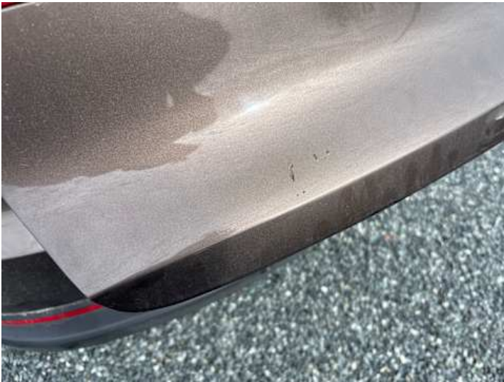
Heckklappe (Unsachgemäß instand gesetzt, Lackschaden)
