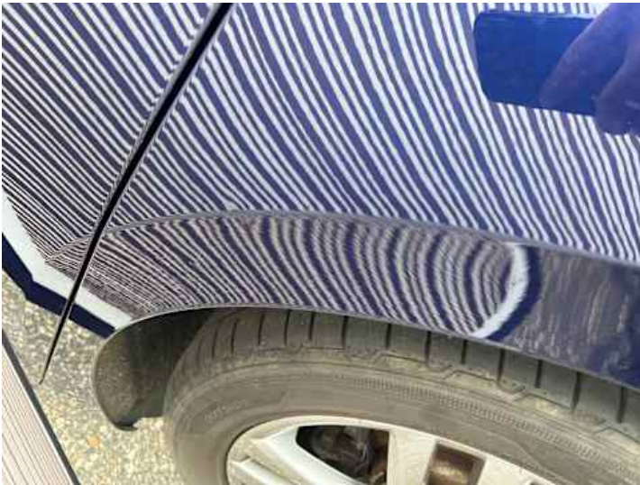
Seitenteil hinten links (Verformung)
