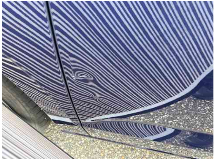
Fahrertür (Verformung, Kratzer)
