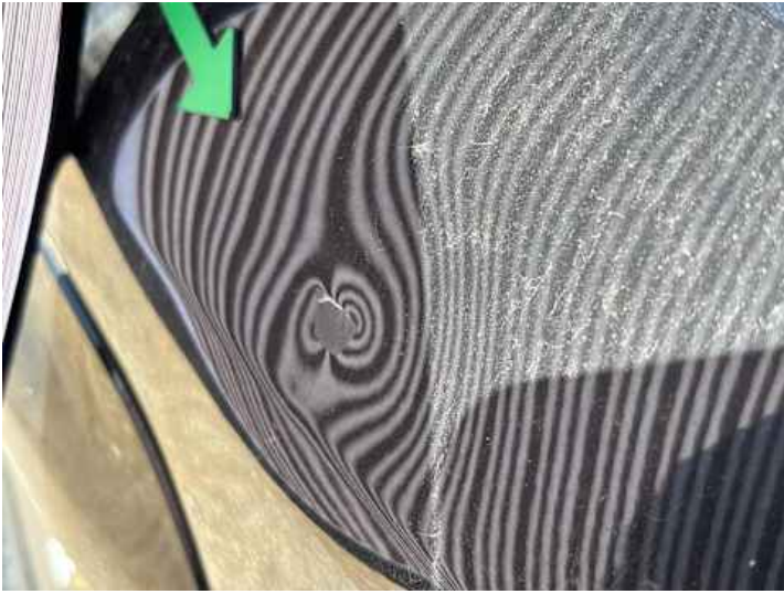
Heckklappe (Kratzer, Delle)
