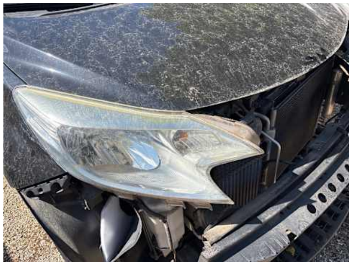
Scheinwerfer (rechts) (Riss/Bruch, Blind)
