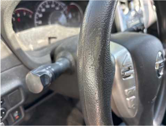
Innenraum (Verschmutzung, Verschleiß)
