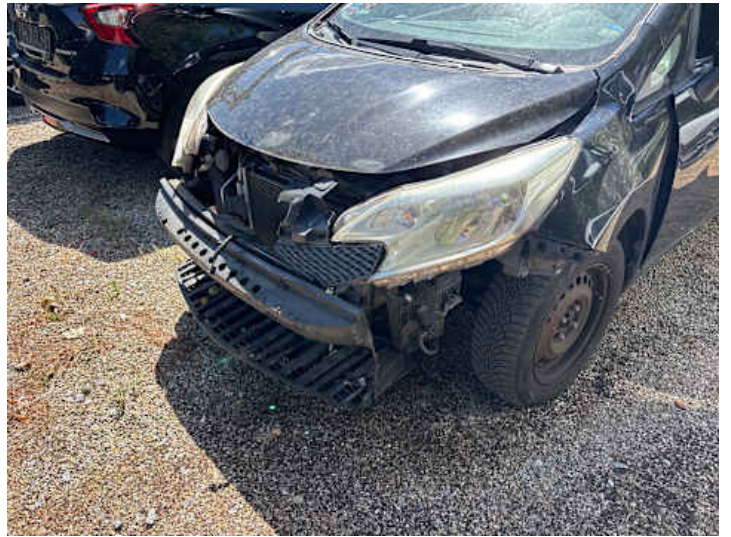
Stoßstange vorne (Riss/Bruch)
