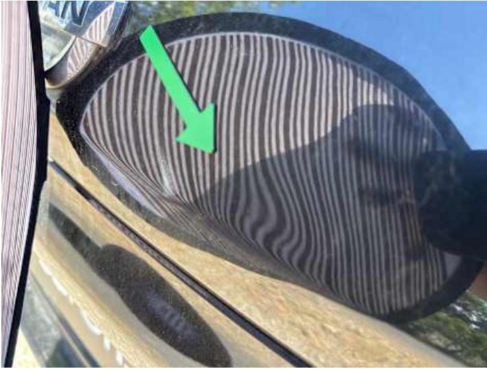
Heckklappe (Kratzer, Delle)
