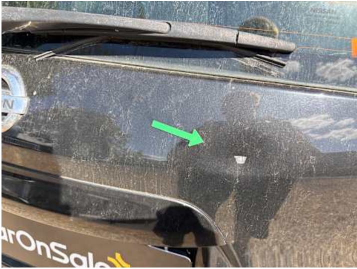
Heckklappe (Kratzer, Delle)
