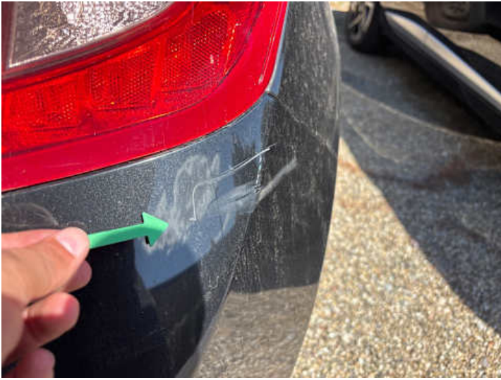
Stoßstange hinten (Kratzer, Riss/Bruch)
