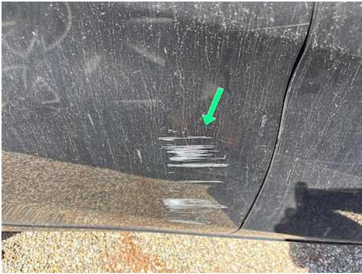
Türe hinten rechts (Kratzer, Verformung)
