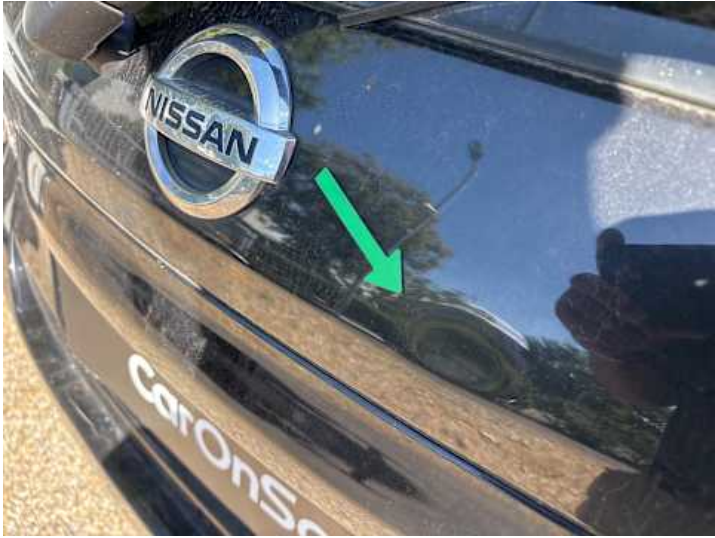
Heckklappe (Kratzer, Delle)
