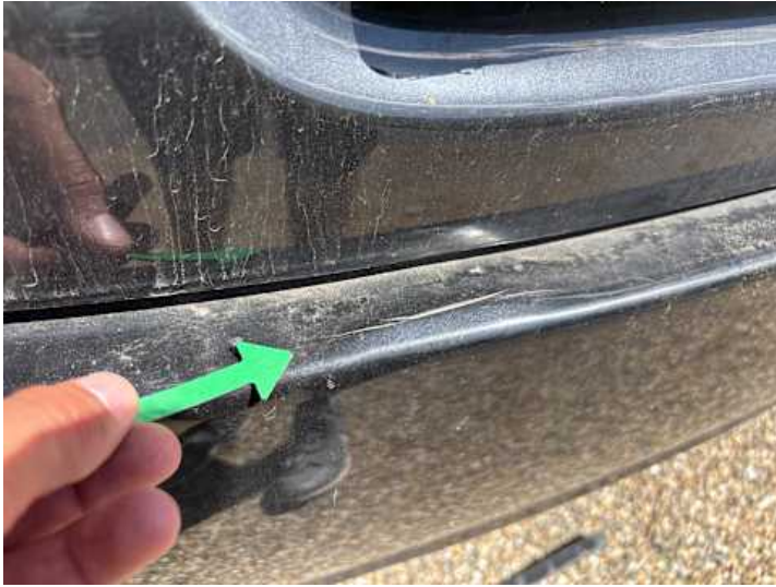
Stoßstange hinten (Kratzer, Riss/Bruch)
