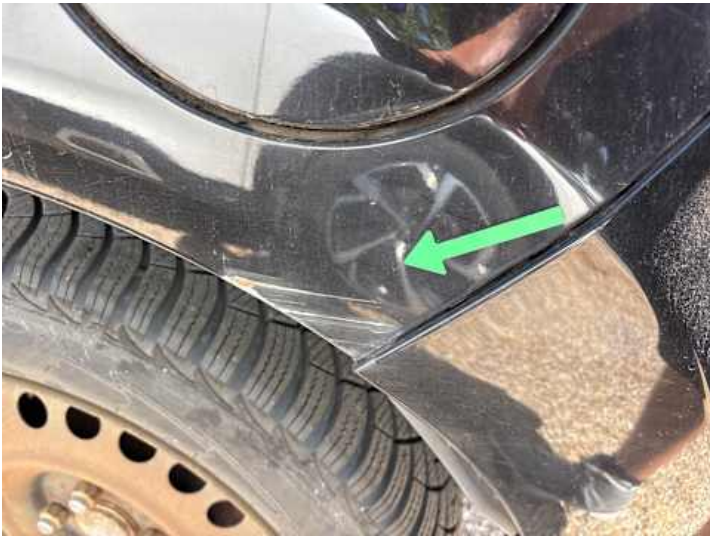
Seitenteil hinten links (Kratzer, Verformung, Rost)
