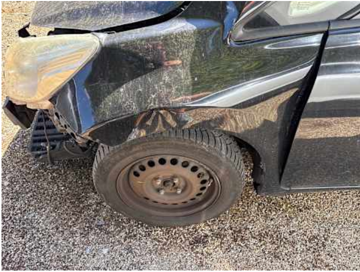
Kotflügel vorne links (Verformung, Riss/Bruch)
