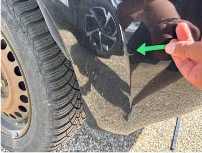
Stoßstange hinten (Kratzer, Riss/Bruch)
