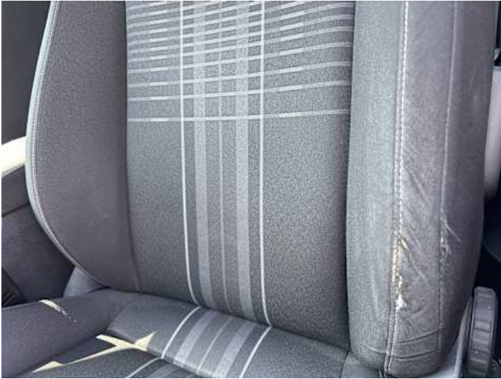
Innenraum (Verschleiß, Riss/Bruch)
