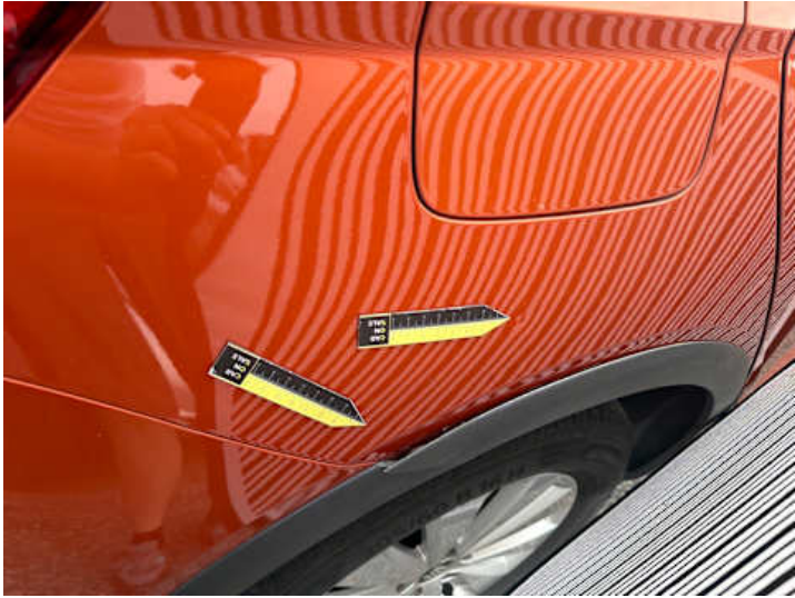
Seitenteil hinten rechts (Delle, Riss/Bruch)
