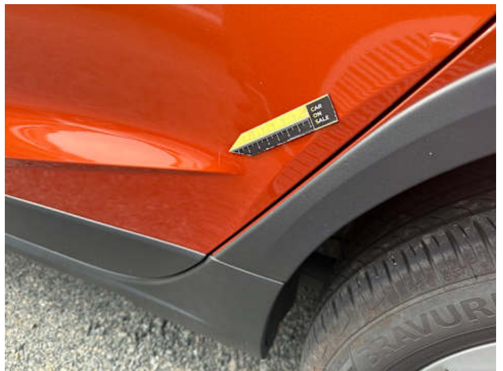
Türe hinten links (Kratzer)
