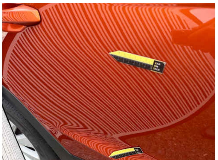
Türe hinten rechts (Delle, Kratzer)
