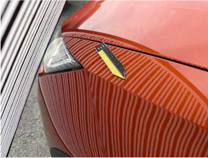
Kotflügel vorne links (Delle, Steinschlag)
