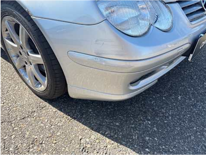
Stoßstange vorne (Kratzer, Lackschaden)
