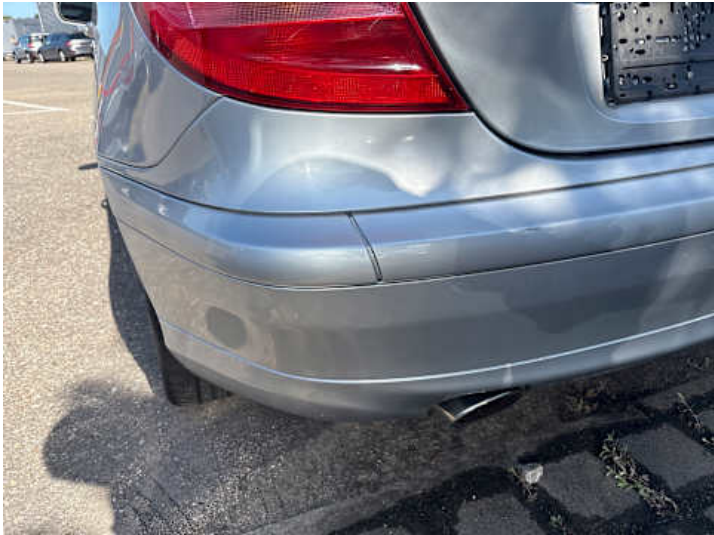
Stoßstange hinten (Kratzer, Lackschaden)
