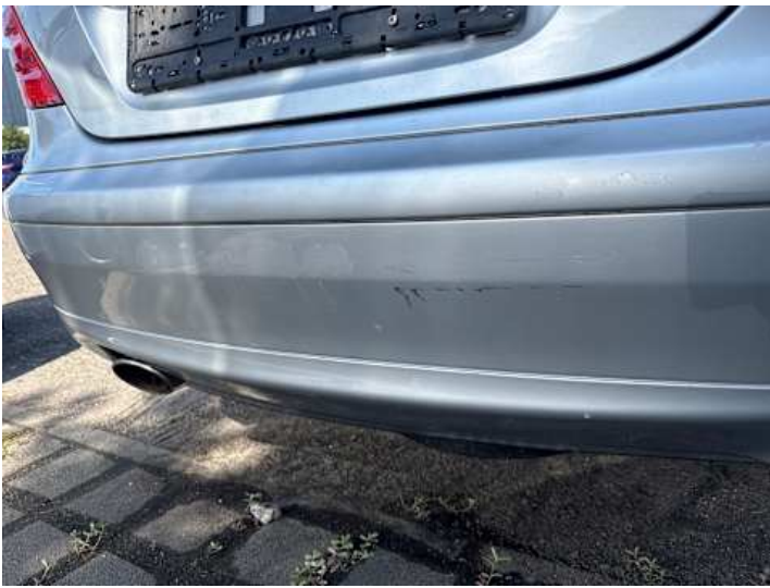
Stoßstange hinten (Kratzer, Lackschaden)
