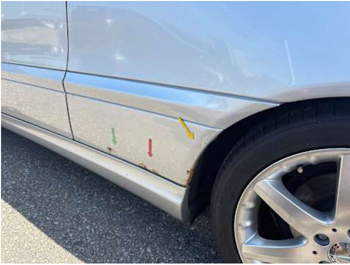
Seitenteil hinten links (Rost)
