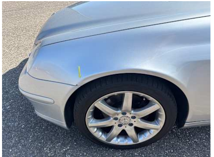
Kotflügel vorne links (Delle, Kratzer, Lackschaden)
