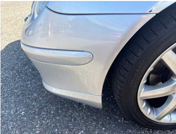
Stoßstange vorne (Kratzer, Lackschaden)
