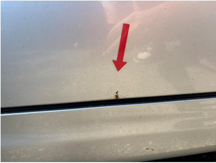
Beifahrertür (Rost, Kratzer, Lackschaden)
