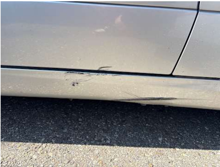
Schweller rechts (Kratzer, Lackschaden, Verformung)
