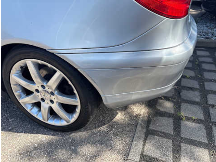
Stoßstange hinten (Kratzer, Lackschaden)
