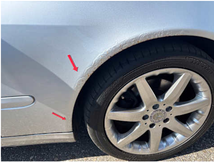
Kotflügel vorne rechts (Rost)
