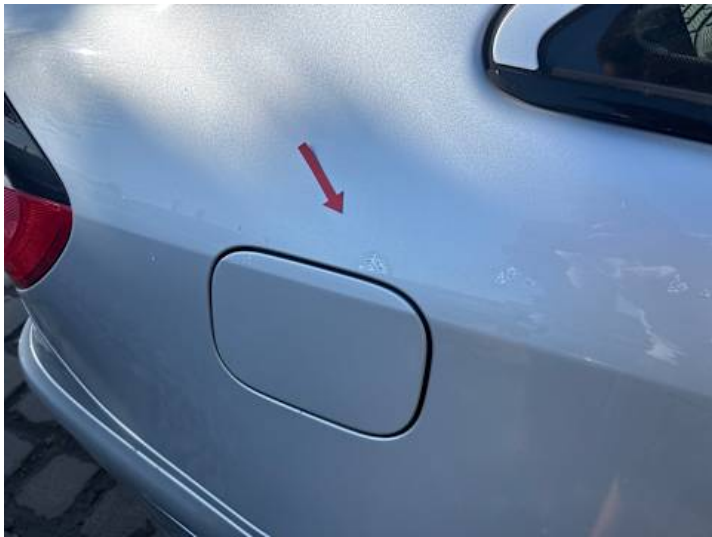
Seitenteil hinten rechts (Kratzer, Lackschaden, Rost)
