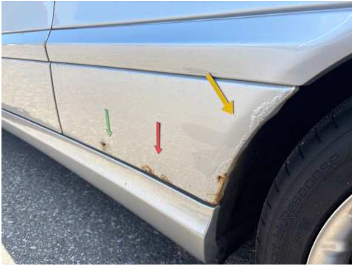
Seitenteil hinten links (Rost)
