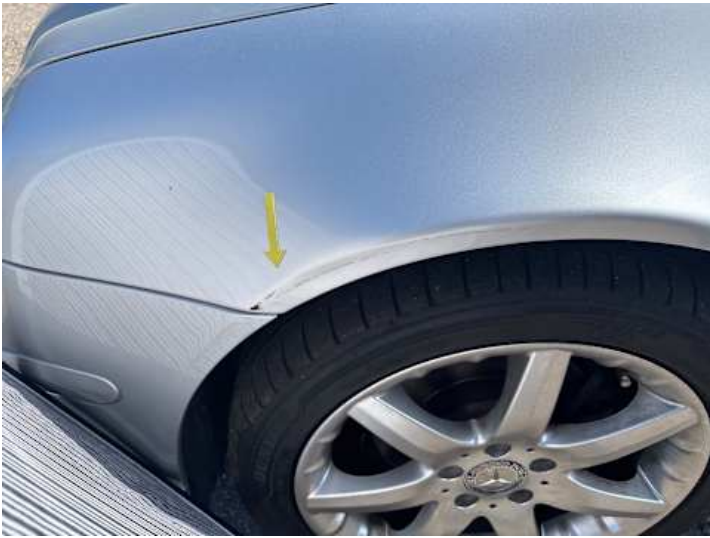
Kotflügel vorne links (Delle, Kratzer, Lackschaden)
