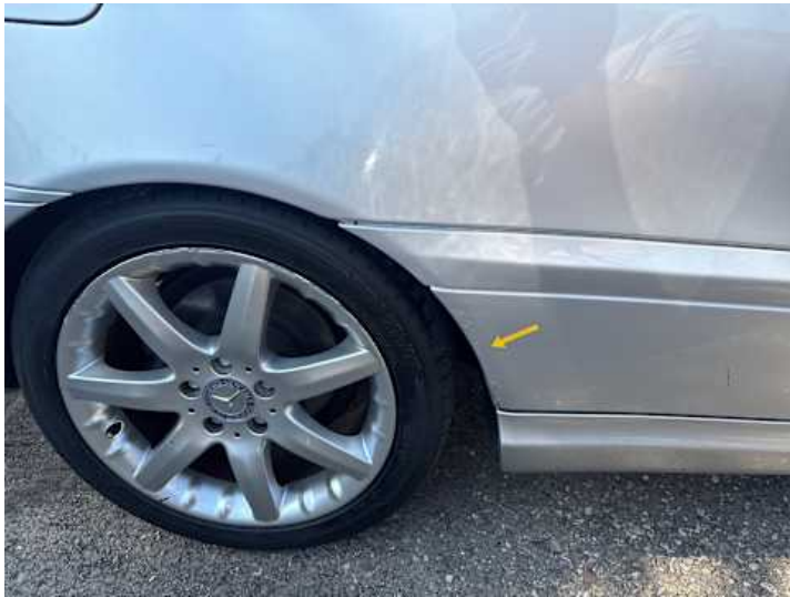
Seitenteil hinten rechts (Kratzer, Lackschaden, Rost)
