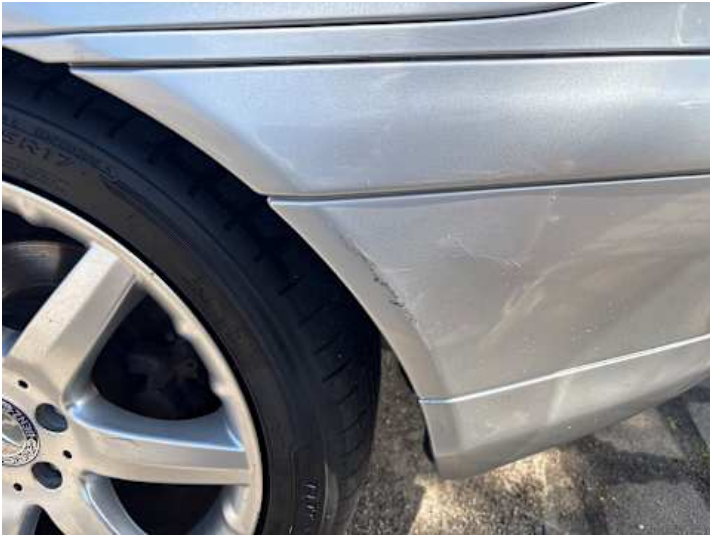
Stoßstange hinten (Kratzer, Lackschaden)
