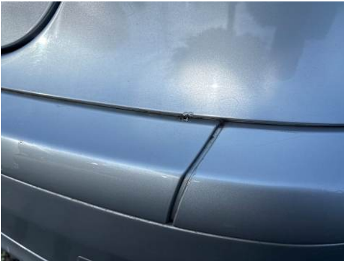
Stoßstange hinten (Kratzer, Lackschaden)
