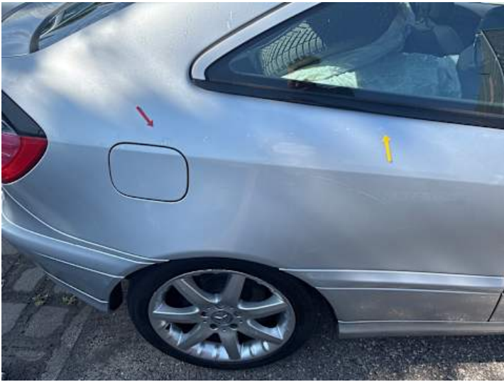
Seitenteil hinten rechts (Kratzer, Lackschaden, Rost)
