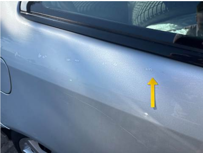
Seitenteil hinten rechts (Kratzer, Lackschaden, Rost)
