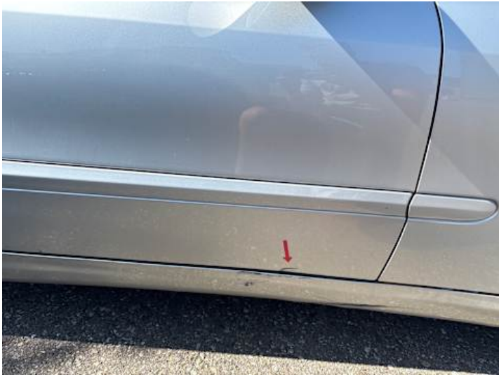
Beifahrertür (Rost, Kratzer, Lackschaden)
