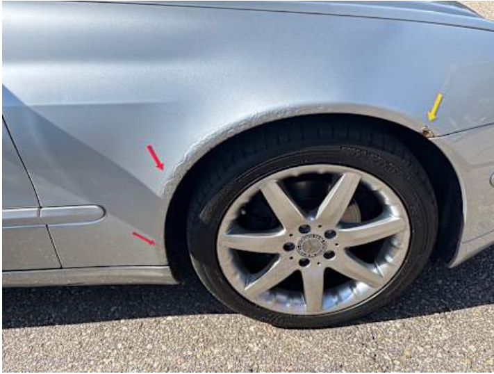
Kotflügel vorne rechts (Rost)
