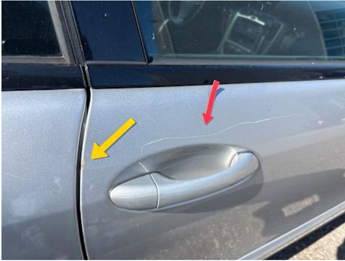
Beifahrertür (Kratzer, Rost, Lackschaden)
