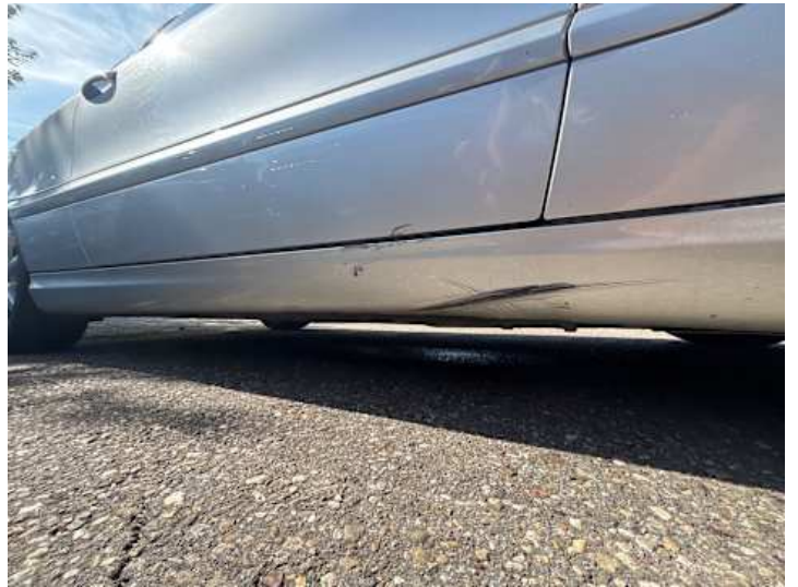
Schweller rechts (Kratzer, Lackschaden, Verformung)
