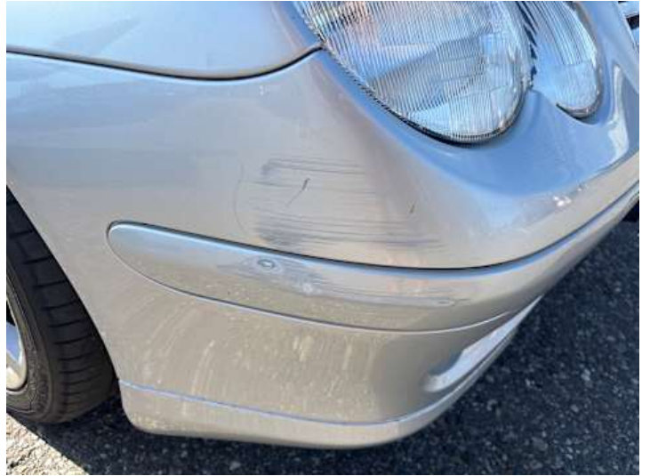
Stoßstange vorne (Kratzer, Lackschaden)
