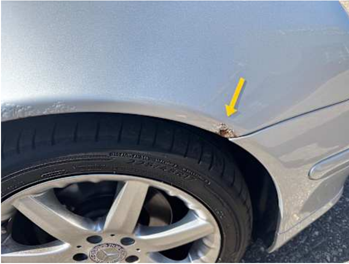
Kotflügel vorne rechts (Rost)
