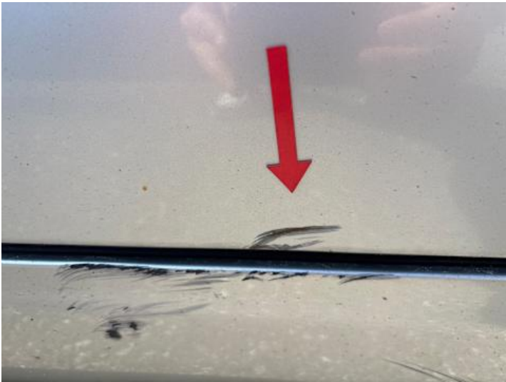
Beifahrertür (Rost, Kratzer, Lackschaden)
