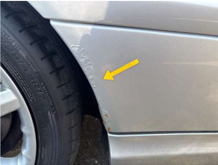
Seitenteil hinten rechts (Kratzer, Lackschaden, Rost)
