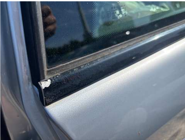
Seitenteil hinten links (Lackschaden)
