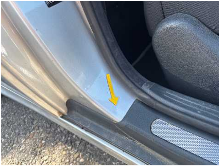
Beifahrertür (Kratzer, Delle)
