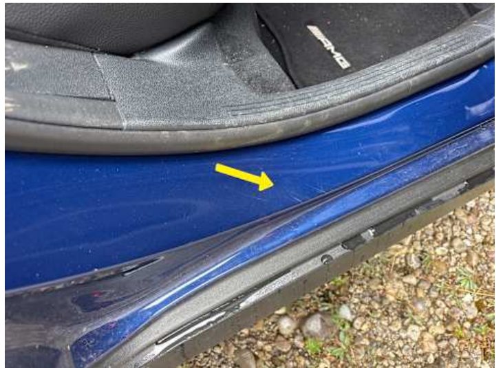
Schweller rechts (Kratzer)
