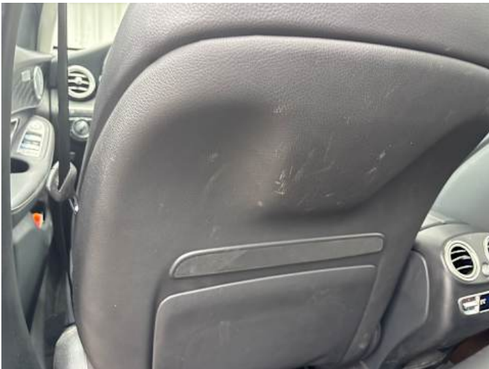
Innenraum (Verschmutzung, Kratzer)
