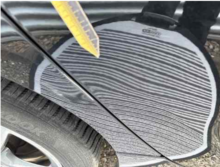
Türe hinten rechts (Delle)
