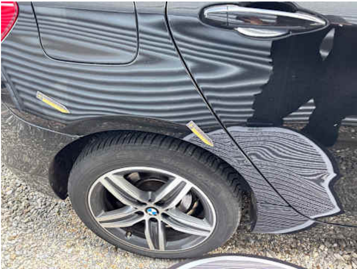
Seitenteil hinten rechts (Delle, Kratzer)
