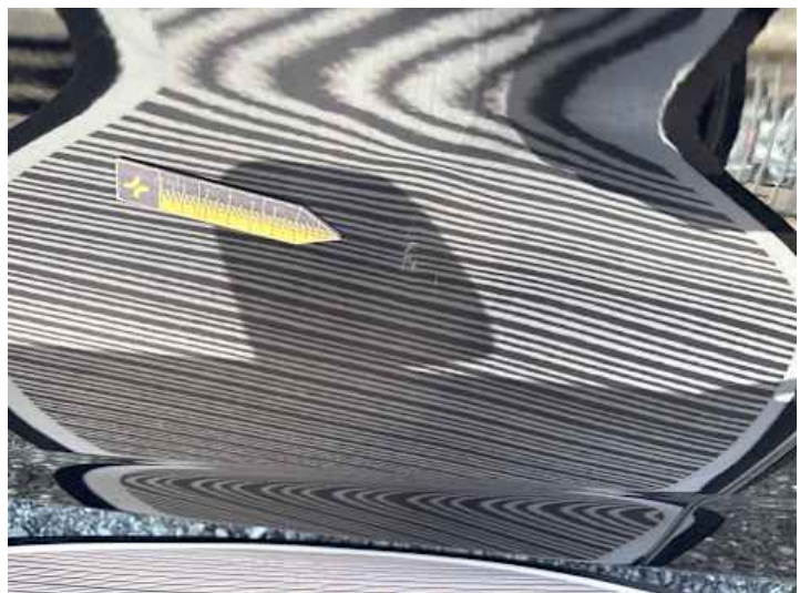
Fahrtür (Kratzer, Delle)
