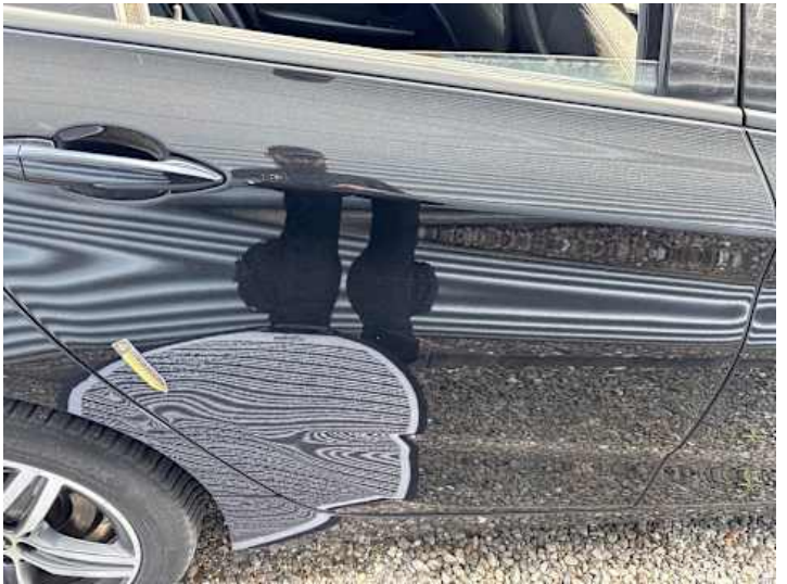
Türe hinten rechts (Delle)
