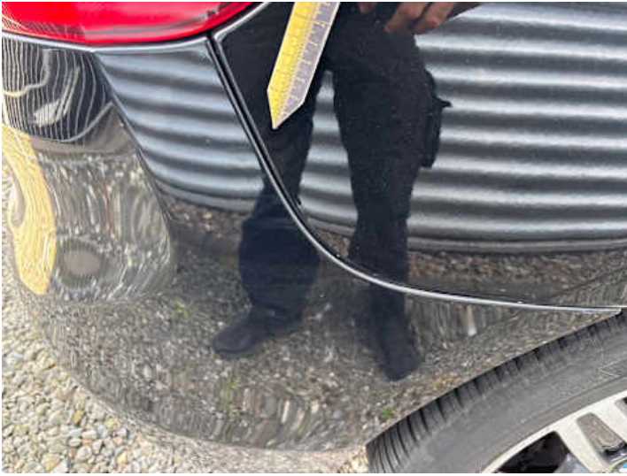
Stoßstange hinten (Spaltmaße ungenau)
