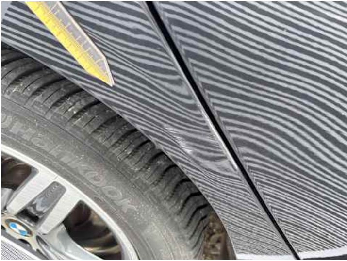
Seitenteil hinten rechts (Delle, Kratzer)
