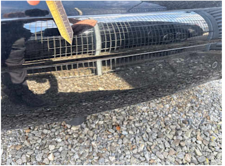
Stoßstange hinten (Kratzer)
