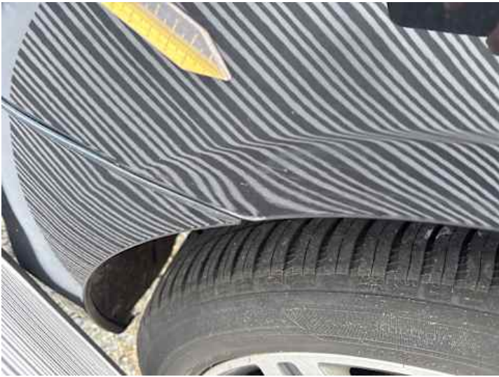
Seitenteil hinten rechts (Delle, Kratzer)
