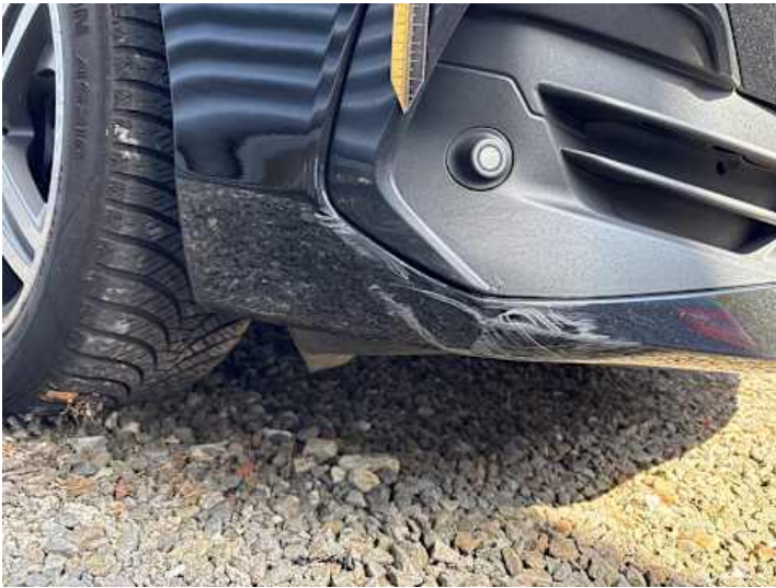
Stoßstange vorne (Kratzer, Riss/Bruch)
