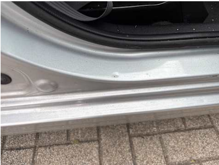
Schweller rechts (Delle, Lackschaden)
