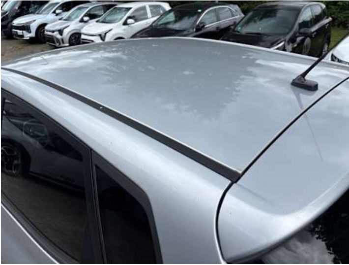
Dach (Delle, Lackschaden, Rost)
