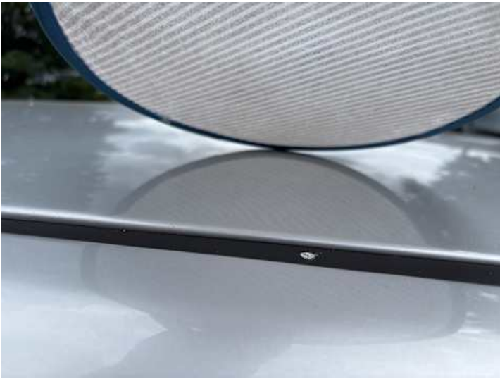
Dach (Delle, Lackschaden, Rost)
