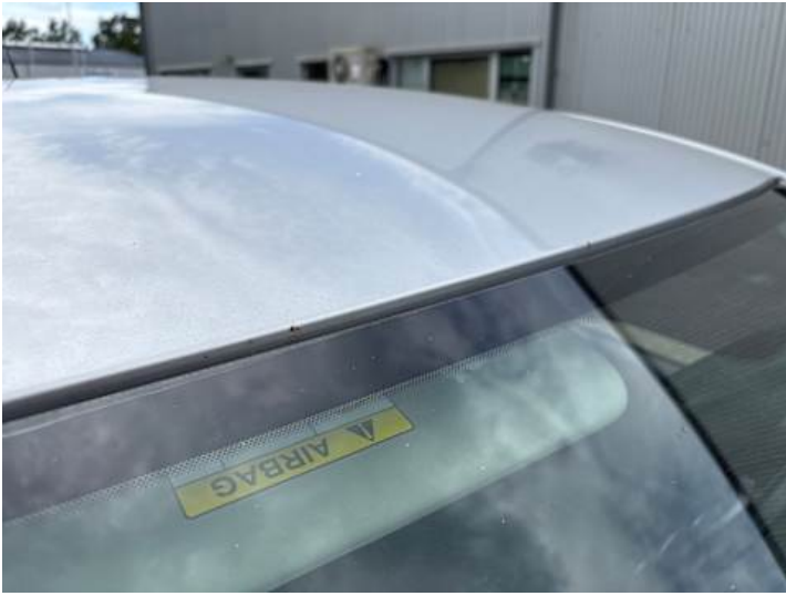
Dach (Delle, Lackschaden, Rost)
