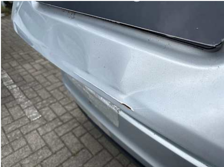
Heckklappe (Lackschaden, Rost, Verformung)
