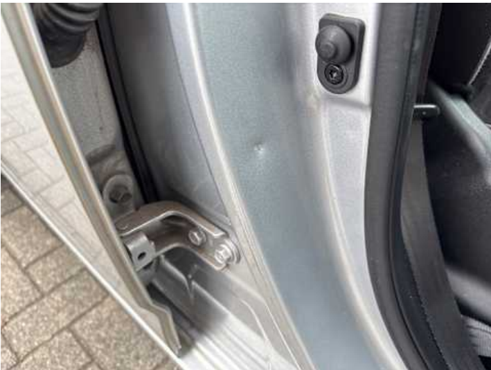
Schweller rechts (Delle, Lackschaden)
