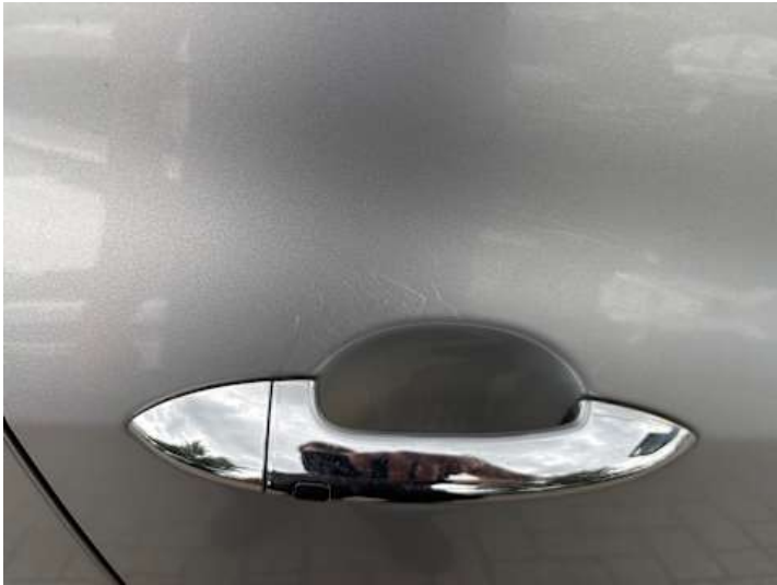
Beifahrtür (Kratzer, Lackschaden)
