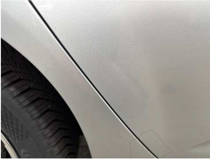
Türe hinten rechts (Kratzer)
