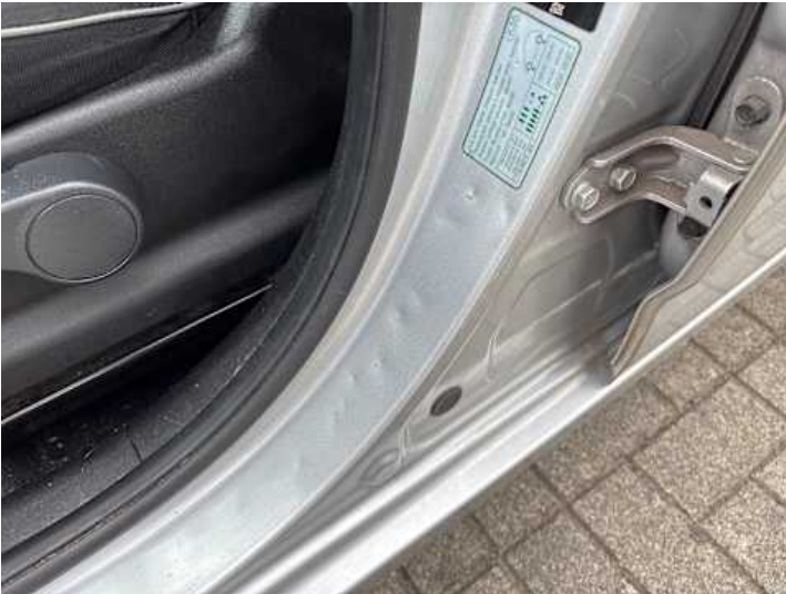
Schweller links (Lackschaden, Delle)
