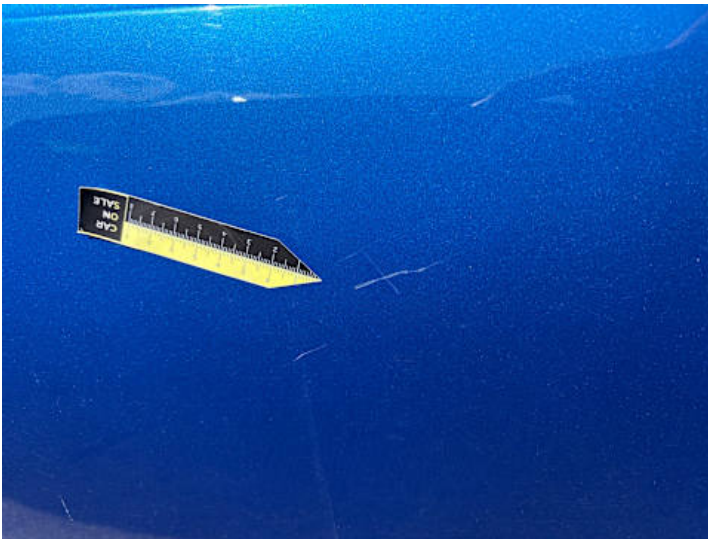
Türe hinten rechts (Lackschaden, Kratzer)
