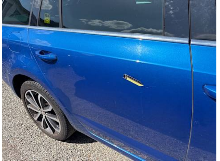
Türe hinten rechts (Lackschaden, Kratzer)
