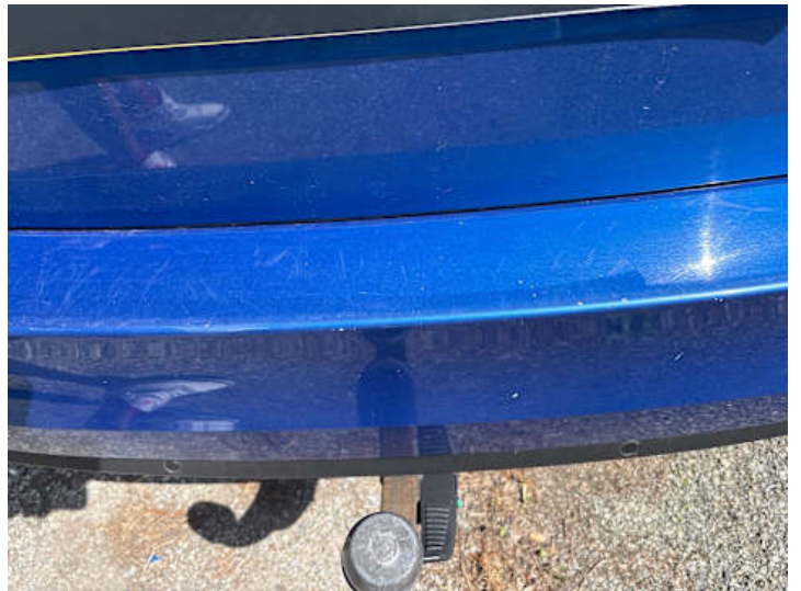
Stoßstange hinten (Kratzer, Lackschaden)
