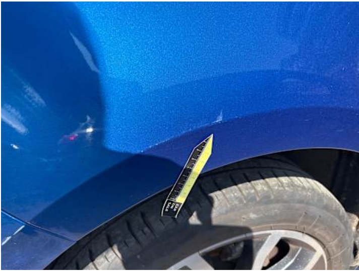
Seitenteil hinten rechts (Kratzer, Lackschaden)
