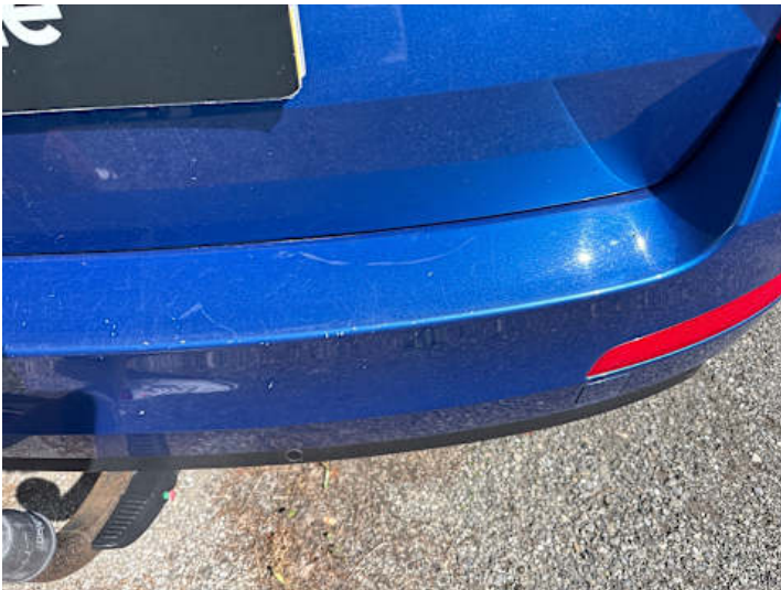
Stoßstange hinten (Kratzer, Lackschaden)
