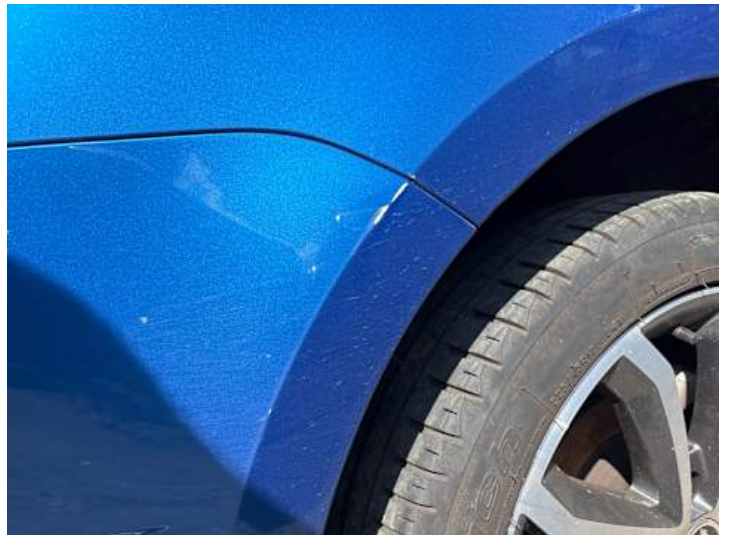
Stoßstange hinten (Kratzer, Lackschaden)
