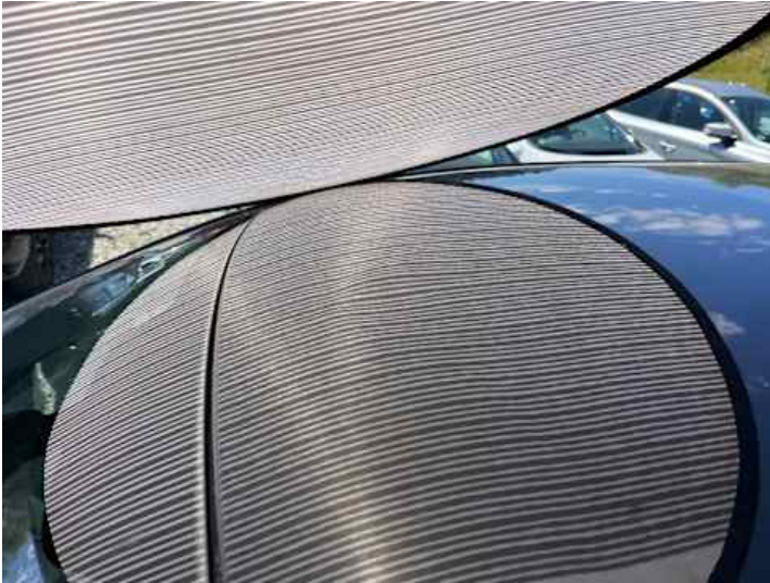
Dach (Delle, Verformung)
