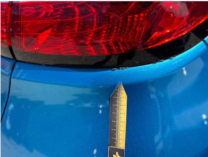
Stoßstange hinten (Lackschaden, Unsachgemäß instand gesetzt)
