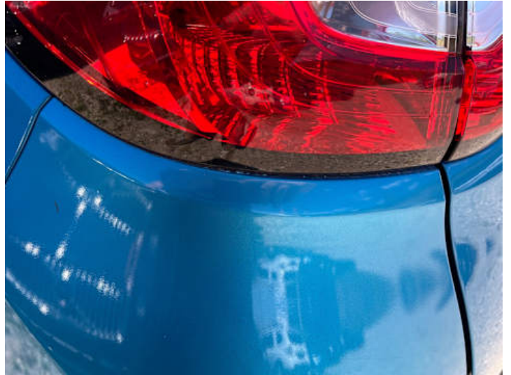
Stoßstange hinten (Lackschaden, Unsachgemäß instand gesetzt)
