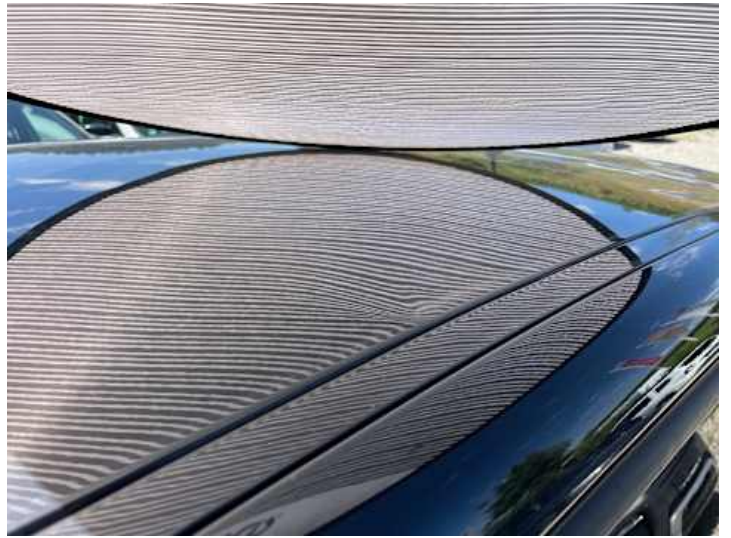
Dach (Delle, Verformung)
