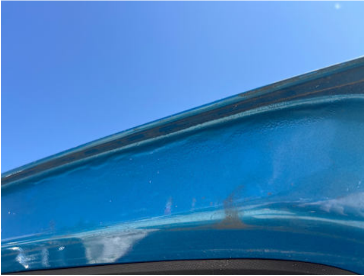
Heckklappe (Lackschaden, Rost, Unsachgemäß instand gesetzt)
