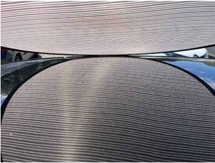
Dach (Delle, Verformung)
