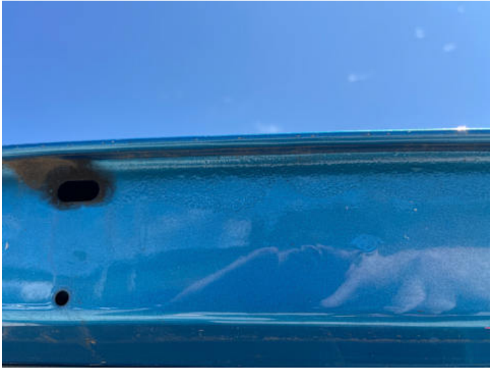
Heckklappe (Lackschaden, Rost, Unsachgemäß instand gesetzt)
