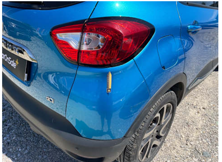
Stoßstange hinten (Lackschaden, Unsachgemäß instand gesetzt)
