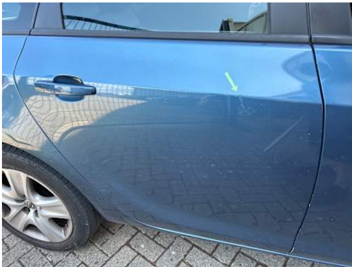
Türe hinten rechts (Delle, Kratzer)
