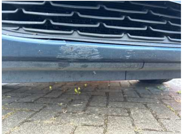
Stoßstange vorne (Riss/Bruch, Kratzer)
