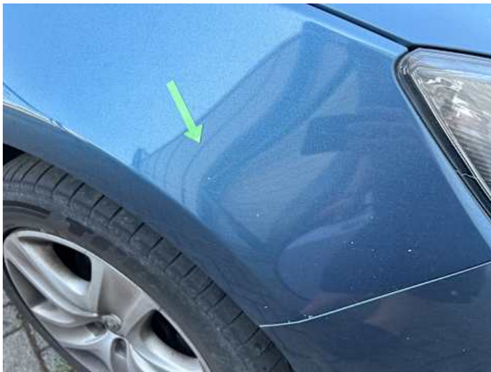
Kotflügel vorne rechts (Steinschlag)
