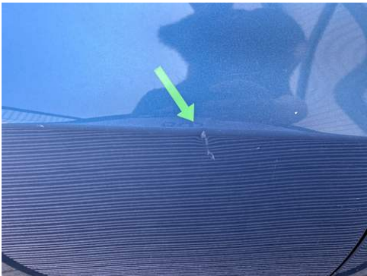
Türe hinten rechts (Delle, Kratzer)
