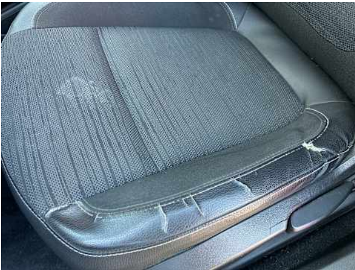
Innenraum (Verschleiß, Verschmutzung)
