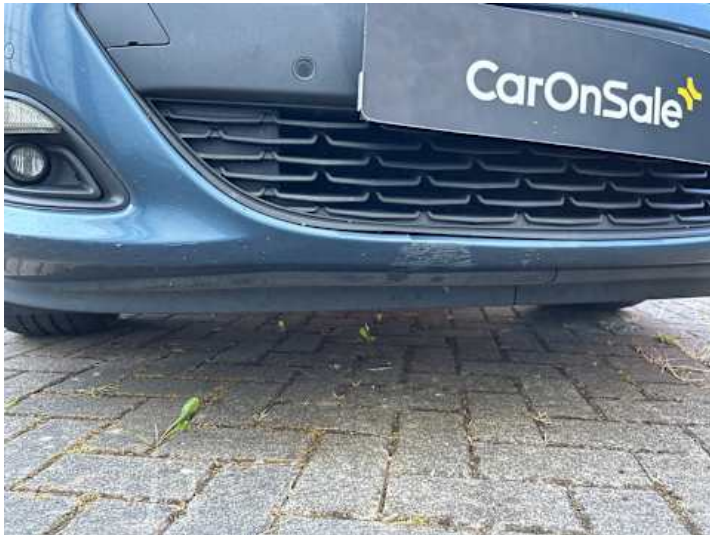
Stoßstange vorne (Riss/Bruch, Kratzer)
