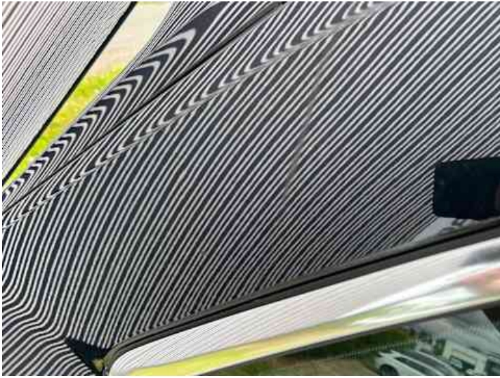
Seitenteil hinten rechts (Delle)
