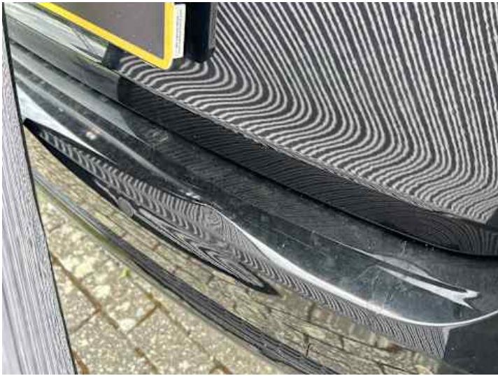
Stoßstange hinten (Verformung, Kratzer)
