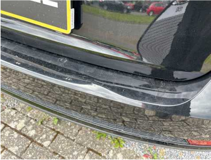
Stoßstange hinten (Verformung, Kratzer)
