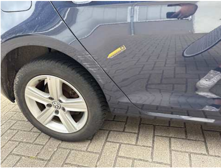
Türe hinten rechts (Lackschaden, Verformung)
