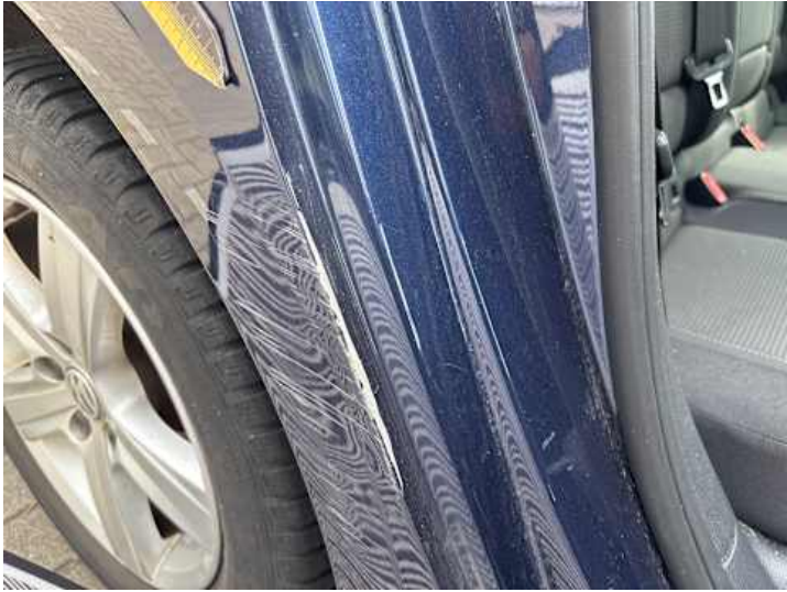
Seitenteil hinten rechts (Lackschaden, Verformung)
