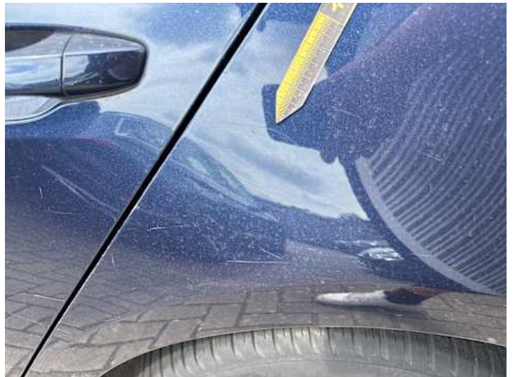
Seitenteil hinten links (Lackschaden, Kratzer)
