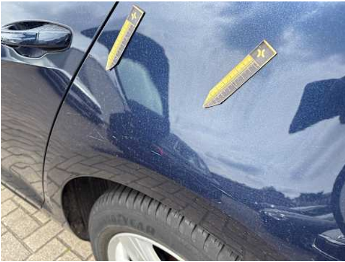
Seitenteil hinten links (Lackschaden, Kratzer)
