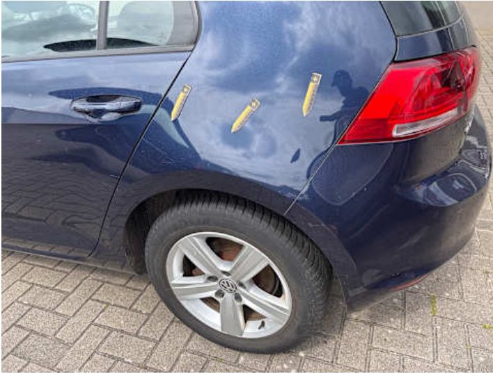
Seitenteil hinten links (Lackschaden, Kratzer)
