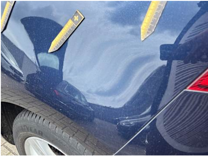
Seitenteil hinten links (Lackschaden, Kratzer)
