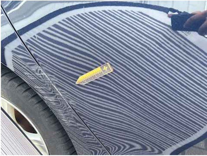
Türe hinten rechts (Lackschaden, Verformung)
