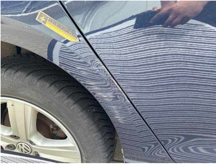
Seitenteil hinten rechts (Lackschaden, Verformung)
