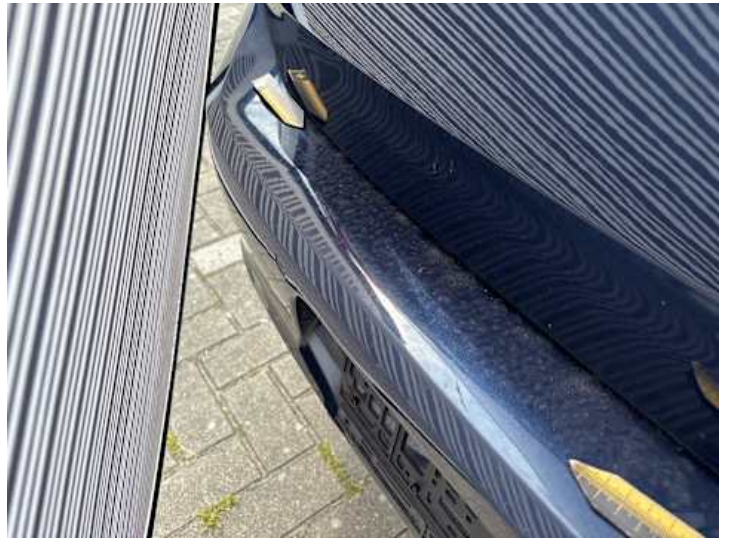
Stoßstange hinten (Lackschaden, Verformung)
