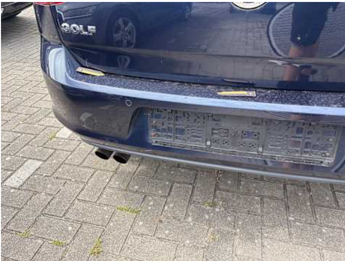
Stoßstange hinten (Lackschaden, Verformung)
