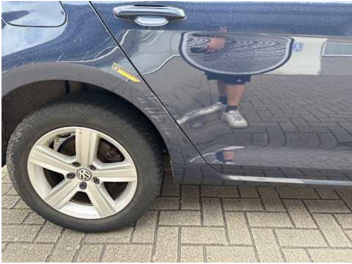
Seitenteil hinten rechts (Lackschaden, Verformung)
