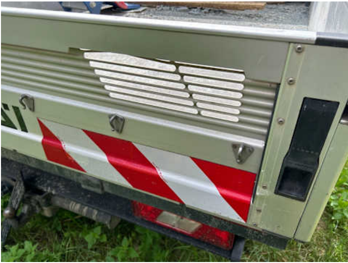
Heckklappe (Kratzer, Verformung)
