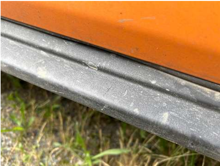
Schweller links (Lackschaden, Kratzer)
