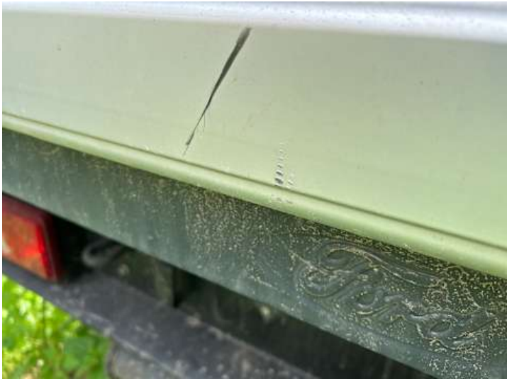
Heckklappe (Kratzer, Verformung)
