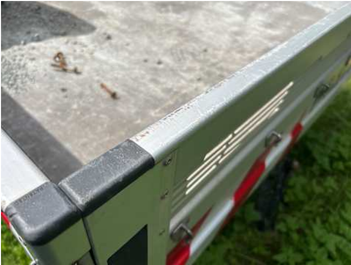
Heckklappe (Kratzer, Verformung)
