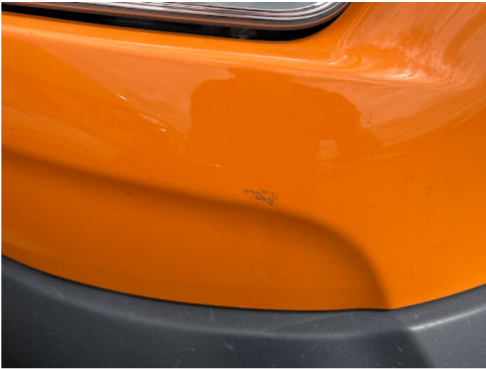
Stoßstange vorne (Verformung, Kratzer)
