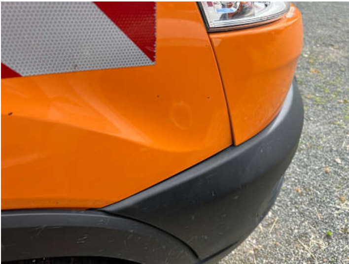
Kotflügel vorne rechts (Spaltmaße ungenau)
