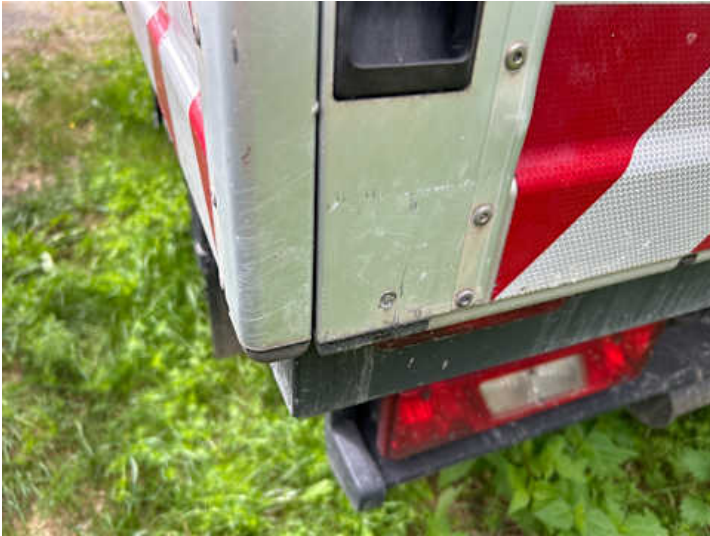
Heckklappe (Kratzer, Verformung)
