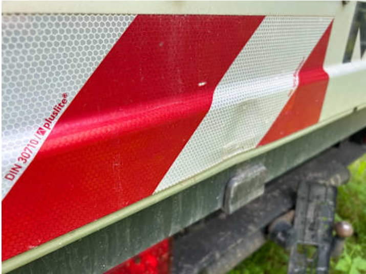
Heckklappe (Kratzer, Verformung)
