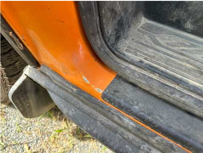
Schweller links (Lackschaden, Kratzer)
