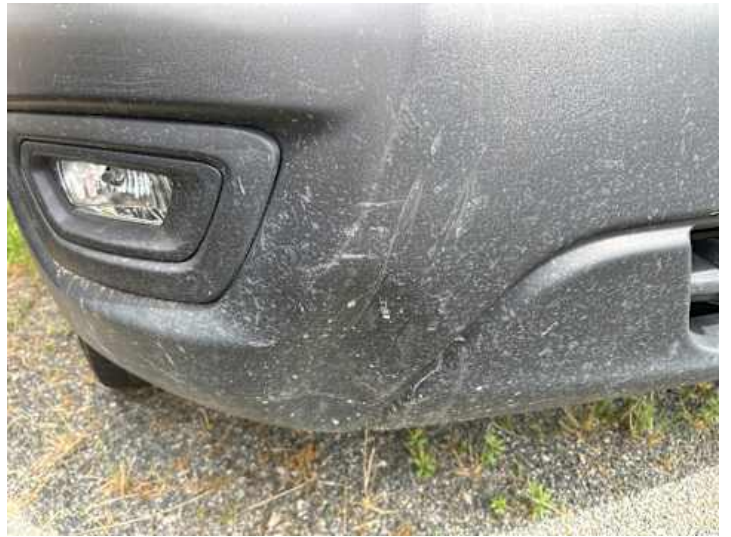
Stoßstange vorne (Verformung, Kratzer)
