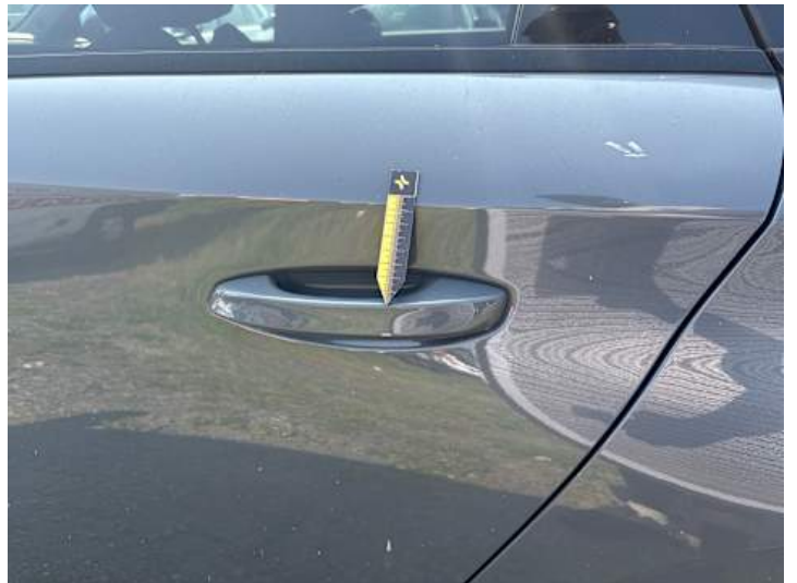
Türe hinten links (Kratzer)
