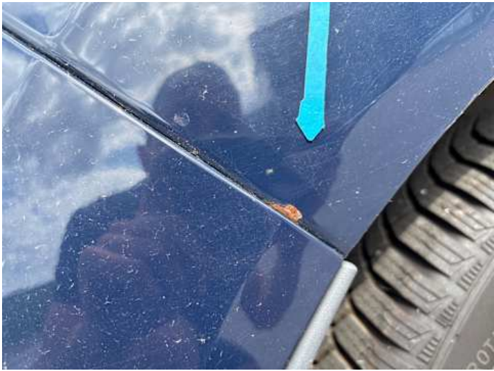
Seitenteil hinten rechts (Rost)
