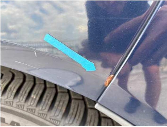
Seitenteil hinten links (Delle, Rost)
