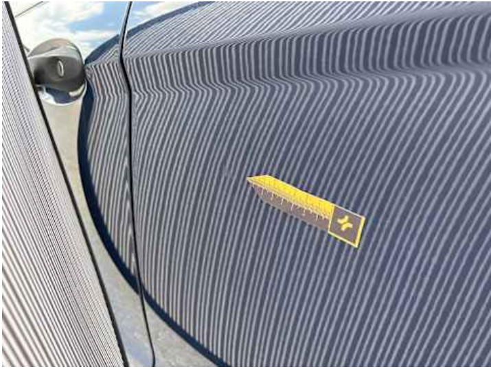
Seitenteil hinten links (Delle, Rost)
