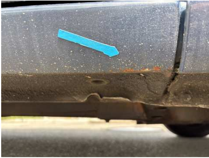
Schweller rechts (Rost)
