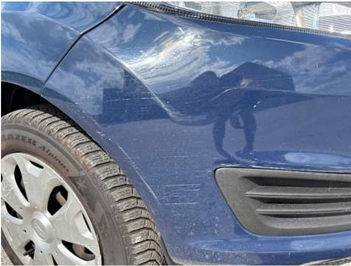
Stoßstange vorne (Kratzer)
