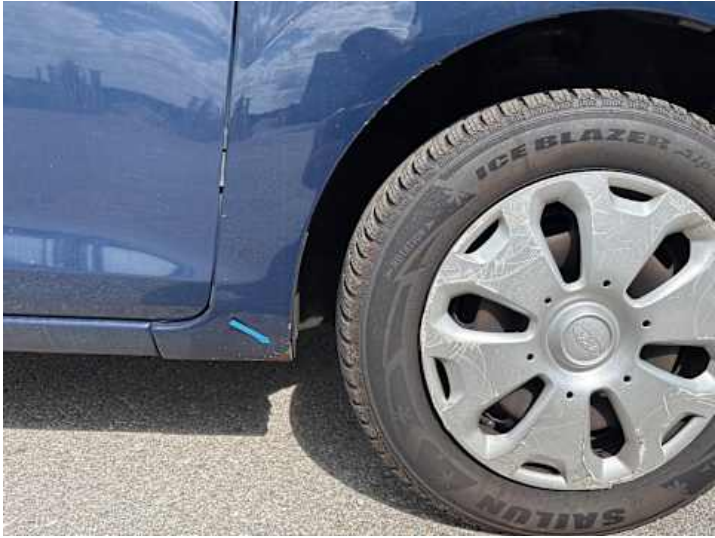
Kotflügel vorne rechts (Rost)
