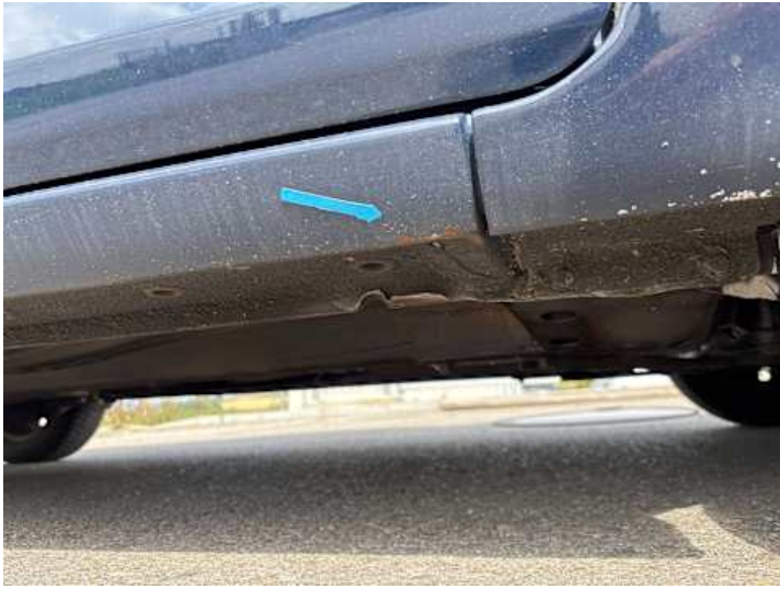
Schweller rechts (Rost)
