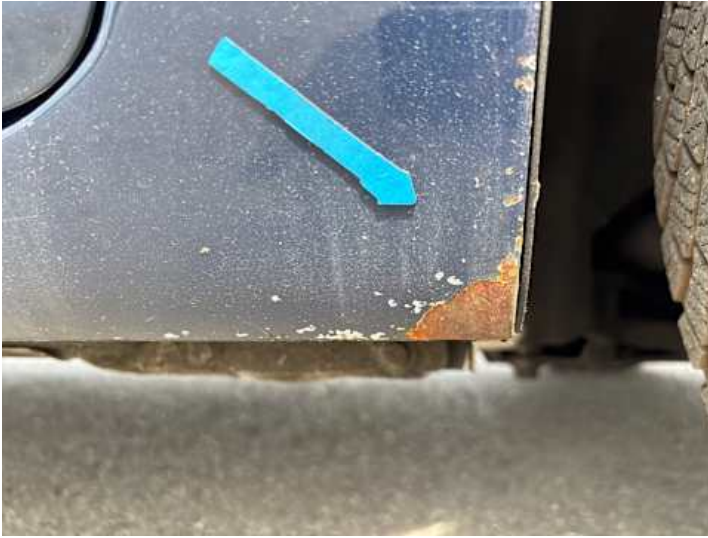
Kotflügel vorne rechts (Rost)
