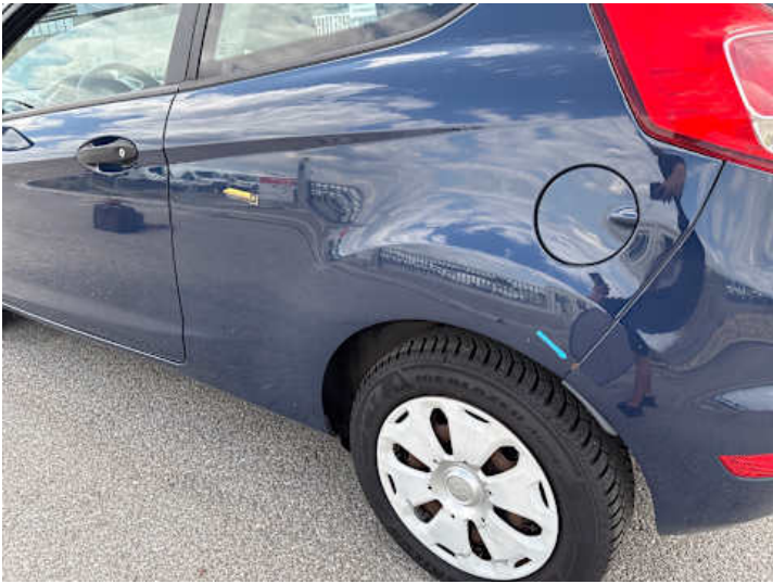
Seitenteil hinten links (Delle, Rost)
