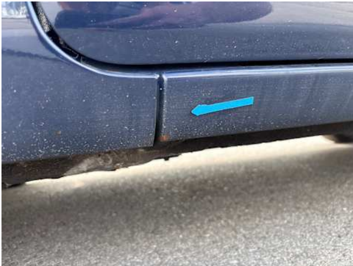
Schweller links (Rost)
